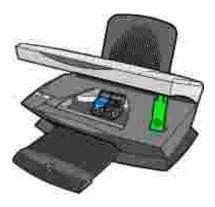
Il supporto della cartuccia di inchiostro si sposta e si arresta in posizione di caricamento, a meno che la stampante non sia occupata.
