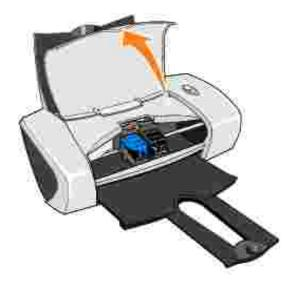
Il supporto delle cartucce di inchiostro si sposta e si arresta nella posizione di caricamento, a meno che la stampante non sia occupata.
