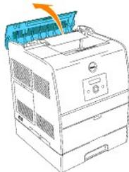
4. Libere las palancas situadas a ambos lados y retire el material de impresión atascado.
