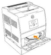
Para cargar sobres de menos de 8.66" (220 mm) de ancho, inserte los sobres con las solapas abiertas y hacia la parte frontal de la impresora, y con la cara de impresión recomendada boca arriba.
