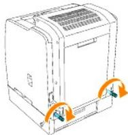
7. Abra el módulo dúplex opcional. Retire la tapa del conector y conecte el conector de la parte inferior izquierda del módulo dúplex opcional a la impresora. Guarde la cubierta original en un lugar seguro.
