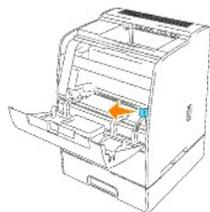
3. Sostenga la varilla de limpieza y desplácela hacia delante y hacia atrás una vez para limpiar el interior de la impresora.
