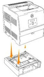
7. Bloquee el módulo de bandeja de 250-hojas estándar en su sitio retirando para ello la bandeja del módulo de bandeja y girando el mecanismo de bloqueo tal como se indica en el gráfico.
