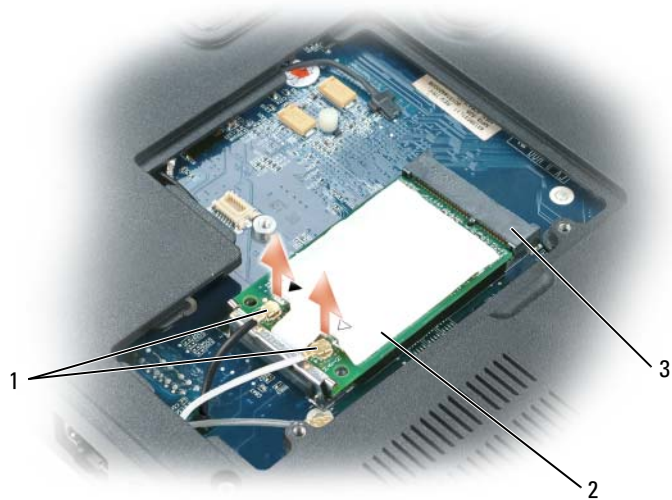
1 câbles d'antenne (2) 2 carte Mini 3 connecteur de carte Mini
