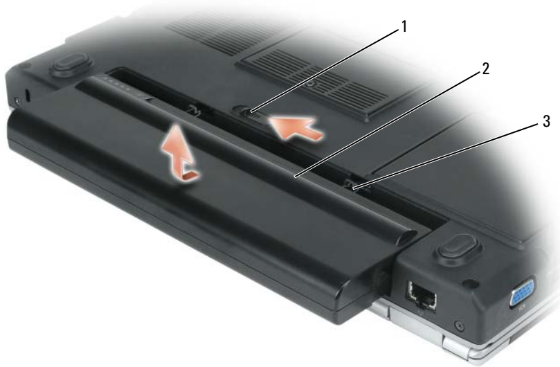
1 電池凹槽釋放門鎖 2 電池（顯示的是 9 芯電池） 3 電池彈片 (2)
