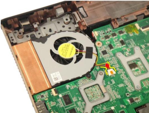
8. Retirez les vis qui fixent le module du ventilateur système.
