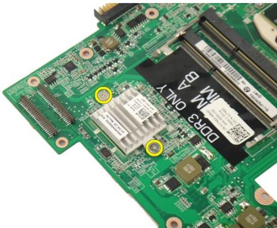
16. Soulevez le dissipateur thermique et retirez-le de la carte système.
