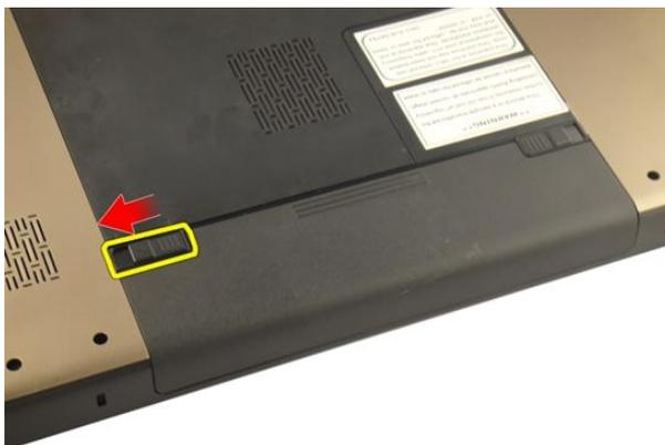
3. Faites glisser la batterie hors du châssis et retirez-la de l'ordinateur.
