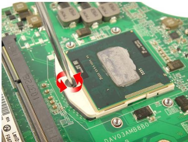
17. Tirez sur le processeur en le tenant droit pour le retirer de sa prise et placez-le dans un emballage antistatique.
