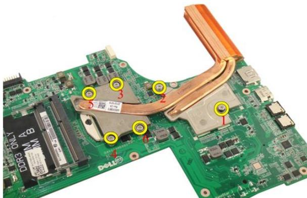
16. Soulevez le dissipateur thermique et retirez-le de la carte système.
