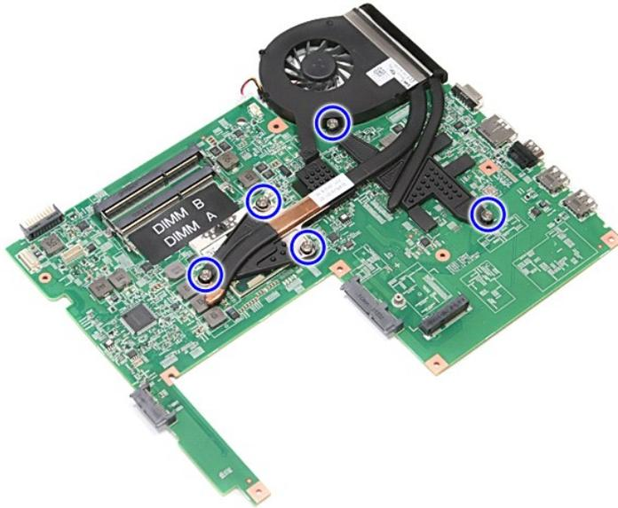
15. Sollevare il gruppo dissipatore di calore e ventola e rimuoverlo dalla scheda di sistema.
