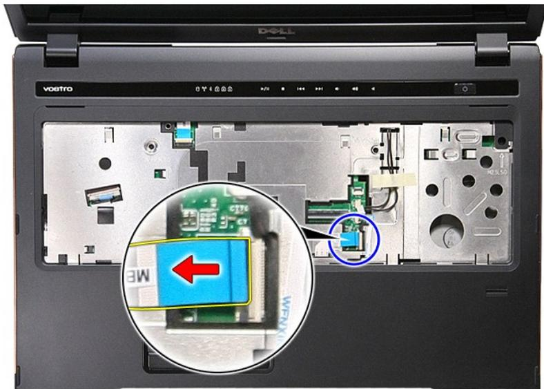
15. Aprire il fermaglio che fissa il cavo dati del lettore di impronte digitali al relativo connettore sulla scheda di sistema.
