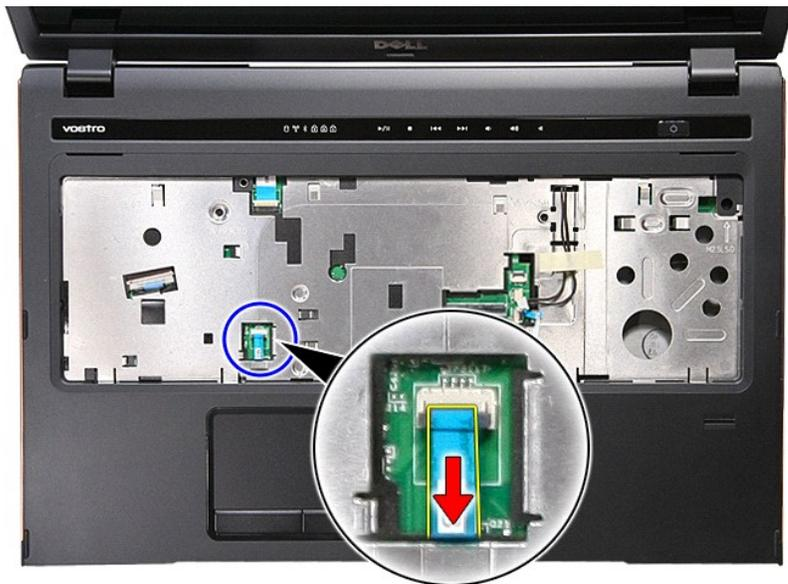
17. Aprire il fermaglio che fissa il cavo dati del lettore di impronte digitali al relativo connettore sulla scheda di sistema.
