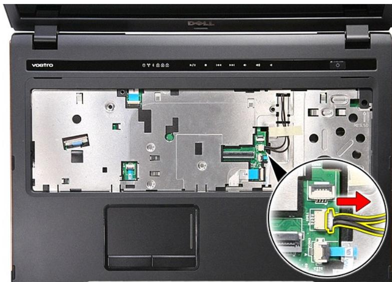
11. Aprire il fermaglio che fissa il cavo dati del lettore di impronte digitali al relativo connettore sulla scheda di sistema.
