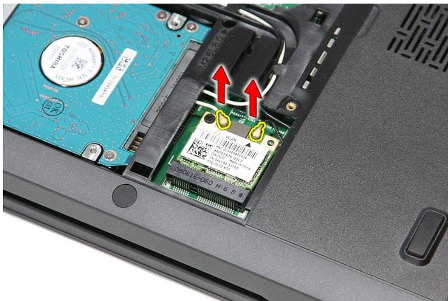
5. Rimuovere la vite che fissa la scheda WLAN alla scheda di sistema.
