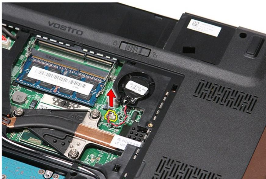
5. Rimuovere delicatamente le linguette che fissano la pila a bottone alla scheda di sistema dalla pila a bottone.
