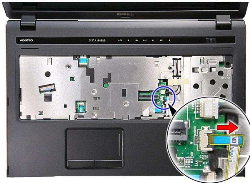
13. Aprire il fermaglio che fissa il cavo dati del lettore di impronte digitali al relativo connettore sulla scheda di sistema.
