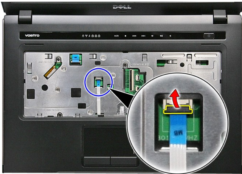
13. タッチパッドデータケーブルをシステム基板のコネクターから取り外します。
