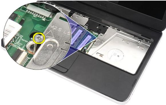
5. マイナスドライバーを使用して、オプティカルドライブを引き出します。オプティカルドライブを外側に向けてスライドさせて、コンピューターから取り外します。
