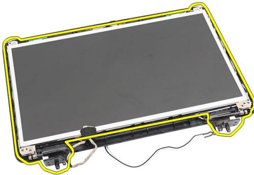
8. 左右のディスプレイブラケットのネジを外して、ディスプレイパネルを取り外します。
