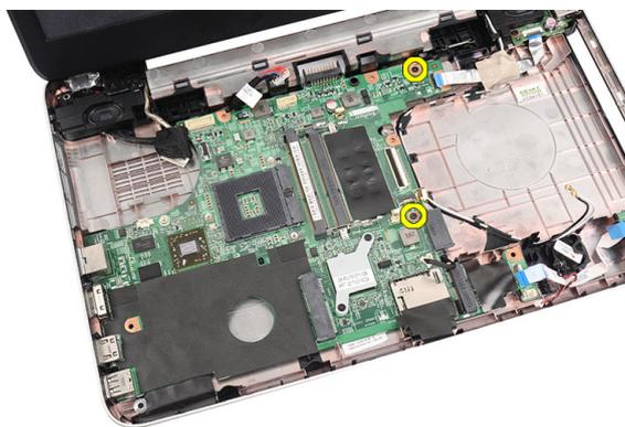
5. システム基板を角度を付けて持ち上げて、LAN、VGA、HDMI、およびUSB ソケットからスライドさせて取り外します。
