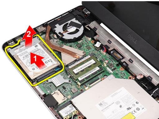
4. ハードドライブブラケットを固定しているネジを外して、ハードドライブから取り外します。
