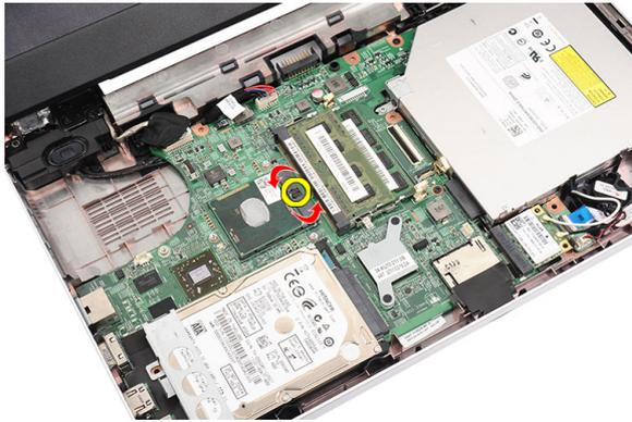
4. プロセッサを持ち上げて、コンピューターから取り外します。
