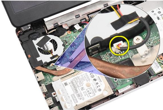
4. 画像に示す手順に従って、ヒートシンクファンアセンブリを固定している拘束ネジを外します。
