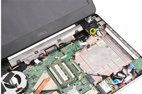
5. USB ボードを持ち上げて、コンピューターから取り外します。
