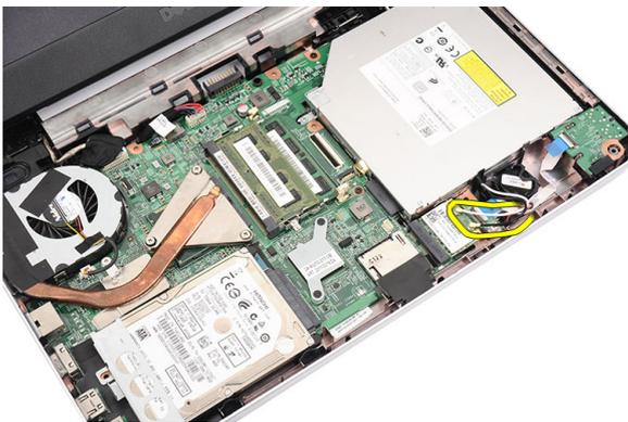
4. ラッチを引き出して、WLAN カードを実装部から取り出します。
