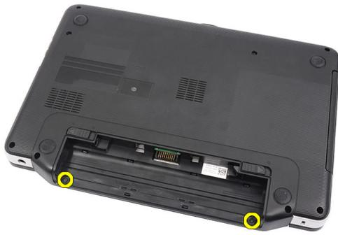
4. コンピューターを裏返して、ヒンジカバーを取り外します。
