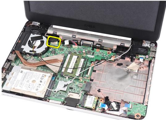
6. 左右のヒンジを固定しているネジを外します。
