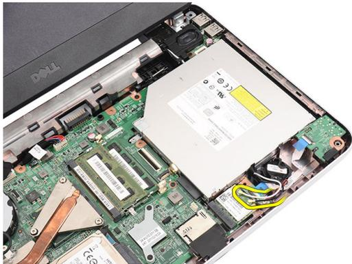
4. コイン型バッテリーを持ち上げて、実装部から取り外します。
