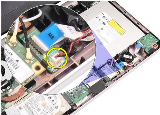
4. コイン型バッテリーをコンピューターから取り外します。
