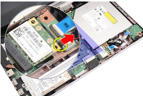
5. WLAN カードをコンピューターから取り外します。
