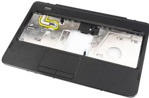
4. パームレストを裏返して、電源ボタン基板をパームレストに固定しているネジを外します。
