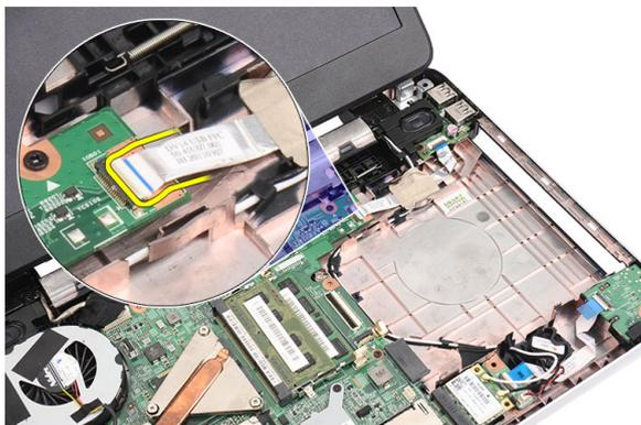
4. USB ボードを固定しているネジを外します。
