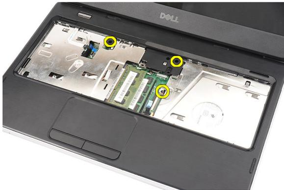
7. プラスチックで、パームレストを端に沿って慎重に引き出します。パームレストを持ち上げて、コンピューターから取り外します。
