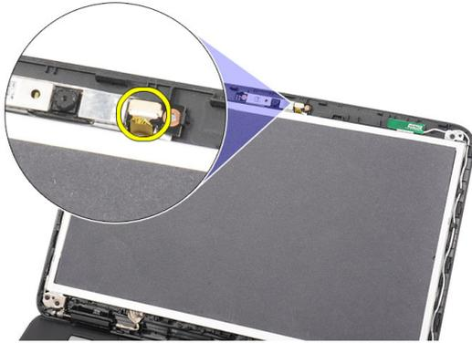
5. ラッチを引き出し、カメラを持ち上げて、コンピューターから取り外します。
