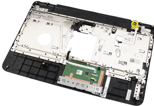
5. 電源ボタン基板を持ち上げて、電源ボタン基板ケーブルを開口部から外します。
