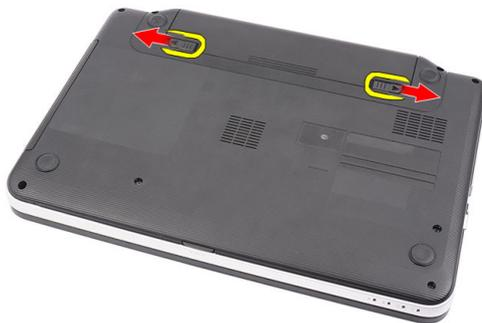
3. バッテリーをスライドさせて、コンピューターから取り外します。
