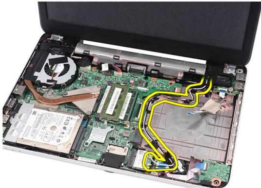
5. ディスプレイケーブルをシステム基板から外します。
