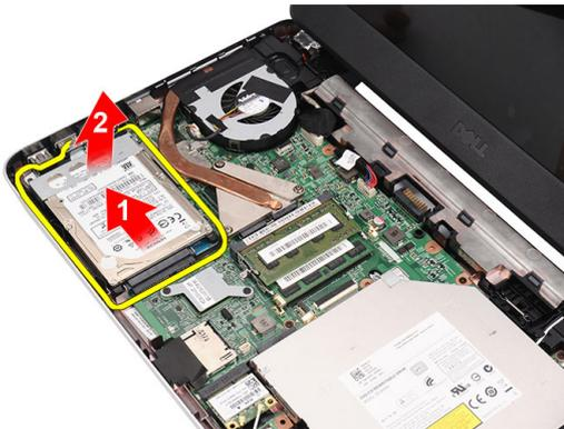
4. Extraiga los tornillos que fijan el soporte de la unidad de disco duro y desengánchela de la unidad de disco duro.
