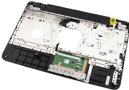
5. Levante el panel del botón de encendido y extraiga su cable a través de la abertura.
