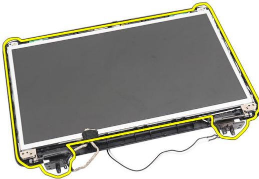
8. Extraiga los tornillos de los soportes izquierdo y derecho de la pantalla y extraiga el panel de la pantalla.
