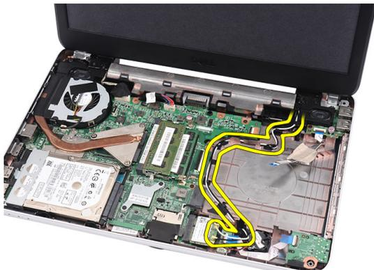
5. Desconecte el cable de la pantalla de la placa base.
