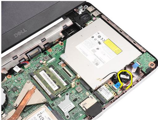
5. Desconecte el cable de la placa de audio de la placa base.
