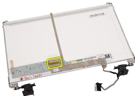
5. Despegue el cable de la pantalla del adhesivo que lo fija al panel de la pantalla y extráigalo.
