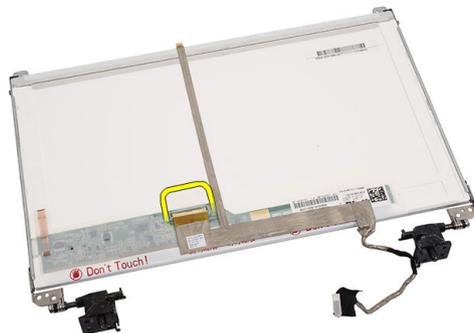
4. Desconecte el cable de la pantalla del panel de la pantalla.
