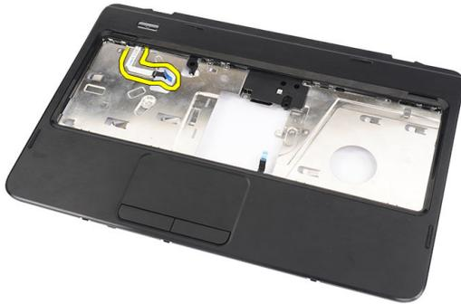
4. Dele la vuelta al reposamanos y extraiga el tornillo que fija el panel del botón de encendido al reposamanos.
