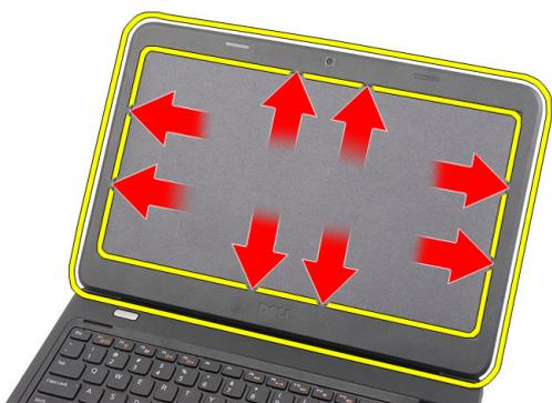
4. Extraiga el embellecedor del ensamblaje de la pantalla.
