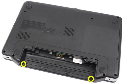
4. Dele la vuelta al equipo y extraiga la cubierta con bisagras.
