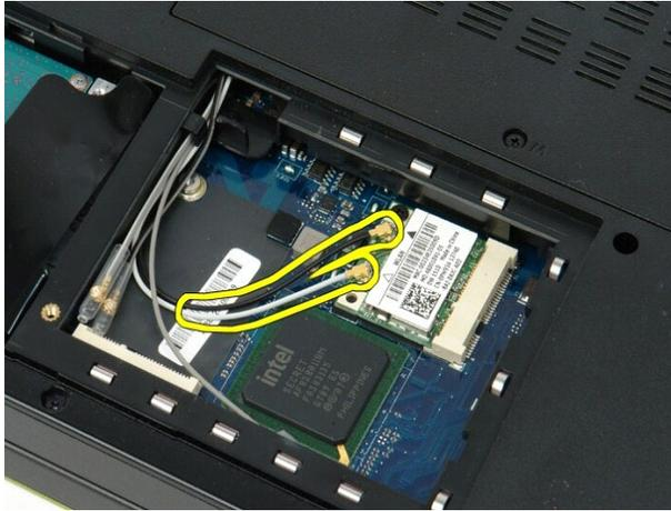
5. WLAN 카드를 시스템 보드에 고정하는 나사를 분리합니다
