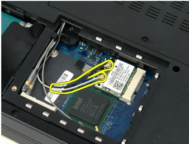
5. WLAN カードをシステム基板に固定しているネジを外します。
