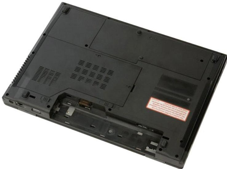
3. ハードドライブとミニカードのアクセスパネルをコンピュータに固定している 2 本のネジを外します。
