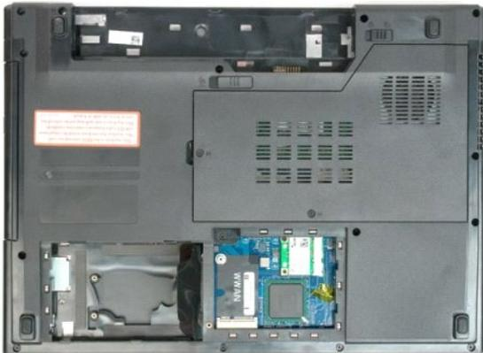
9. パームレストをコンピュータの底部に固定している 13 本のネジを外します。
