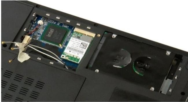
4. ハードドライブをコンピュータの側面方向にスライドさせます。
