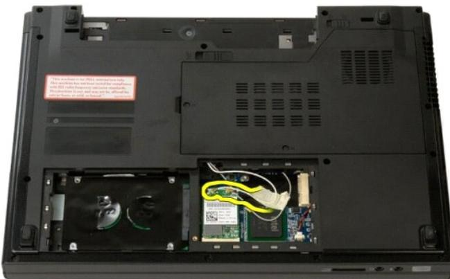
9. カメラケーブルをシステム基板から外します。
