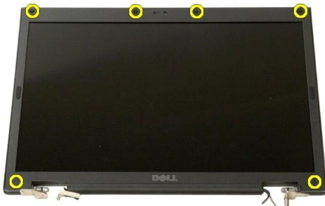
4. ベゼルをディスプレイアセンブリに固定している 6 本のネジを取り外します。
