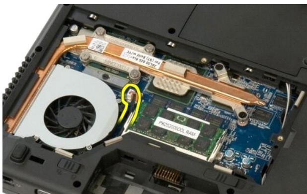
5. ファンをコンピュータに固定している 3 本のネジを外します。
