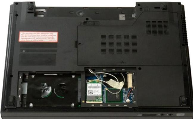
8. アンテナケーブルを WLAN カードから外します。
