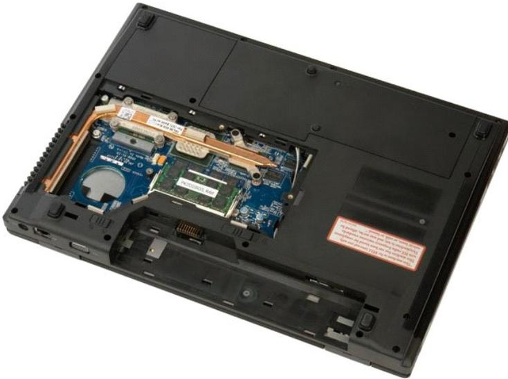
4. メモリモジュールコネクタの両端にある固定クリップをメモリモジュールが持ち上がるまで指先で慎重に広げます。
