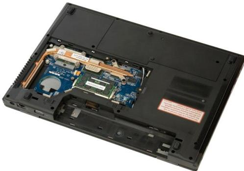
4. オプティカルドライブを所定の位置に固定しているネジを外します。
