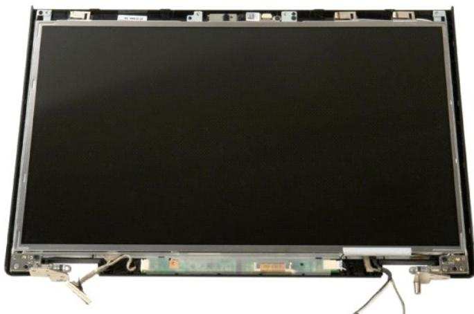
3. ディスプレイインバータをディスプレイアセンブリに固定しているネジを外します。
