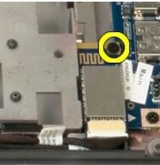
11. コンピュータの前面に最も近い Bluetooth モジュールの端を持ち上げ、モジュールをスロットから持ち上げます。
