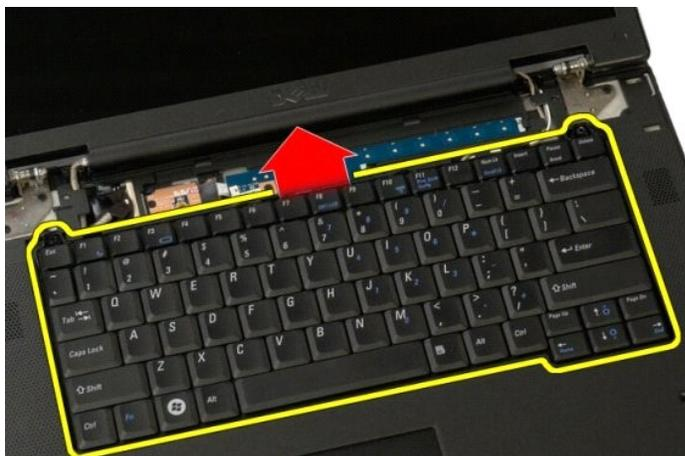
6. キーボードのデータケーブルクリップを開いてリボンケーブルを外します。
