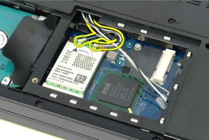
5. WWAN カードをシステム基板に固定しているネジを外します。
