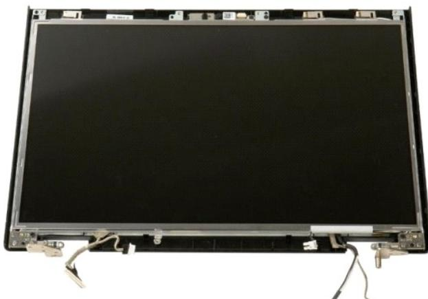
4. LCD ディスプレイパネルをディスプレイアセンブリに固定している 2 本のネジを取り外します。
