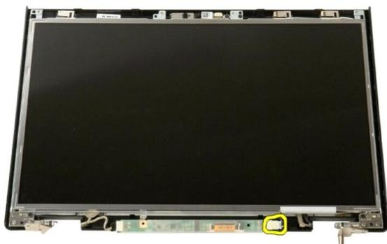
6. データケーブルをディスプレイインバータから外します。
