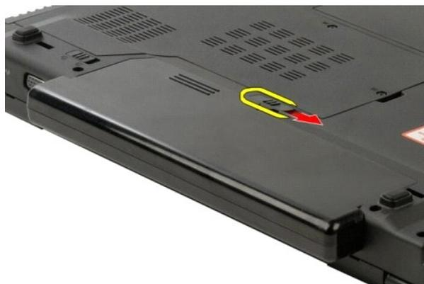
4. バッテリー自体をコンピュータの背面方向に引いて取り外します。
