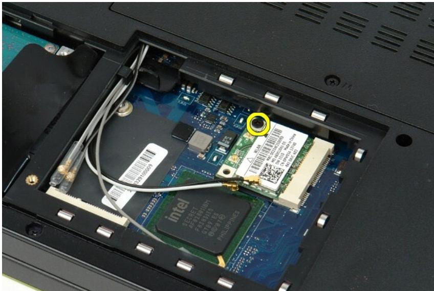
6. WLAN カードをコンピュータから取り外します。
