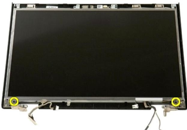
5. LCD ディスプレイパネルをディスプレイアセンブリから取り外します。
