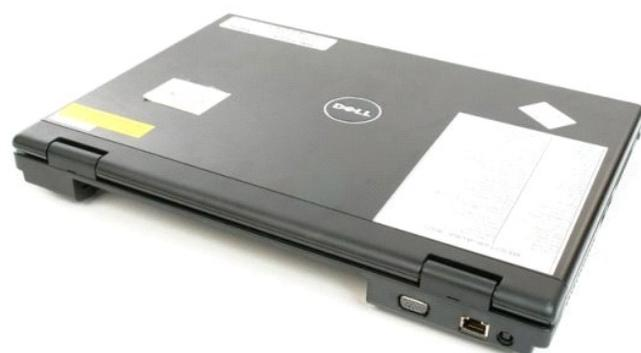
3. プラスチックスクライブを使用して、ヒンジカバーの後部をコンピュータベースから注意深く外します。
