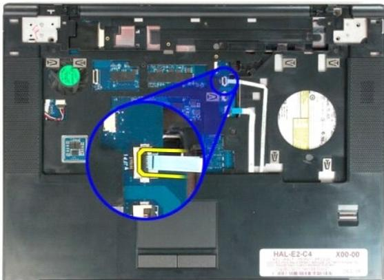
12. タッチパッドのデータケーブルクリップを外します。
