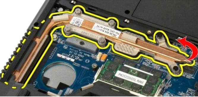
7. ヒートシンクをコンピュータの中央方向にスライドさせてから持ち上げ、コンピュータから取り外します。
