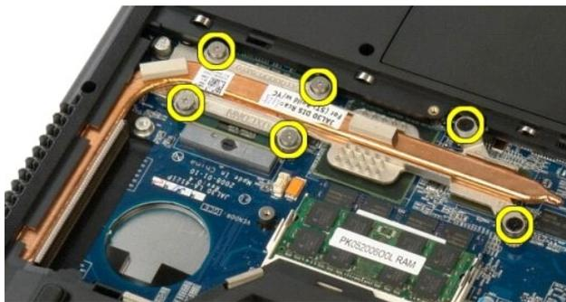
6. コンピュータの中央に最も近いヒートシンクの端を持ち上げます。
