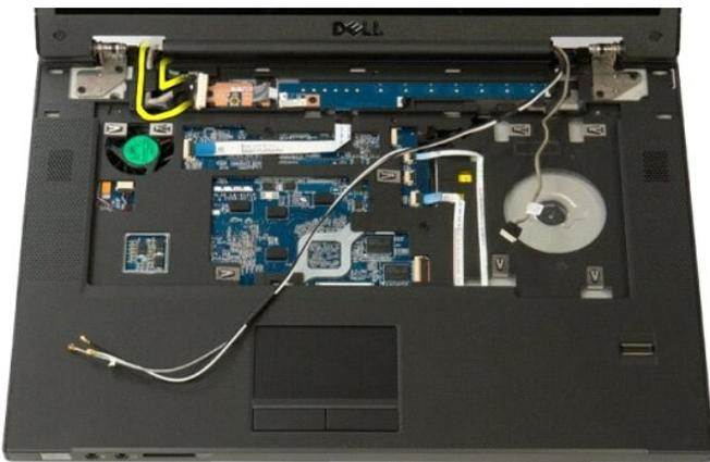
14. ディスプレイアセンブリをコンピュータベースに固定している 4 本のネジを外します。
