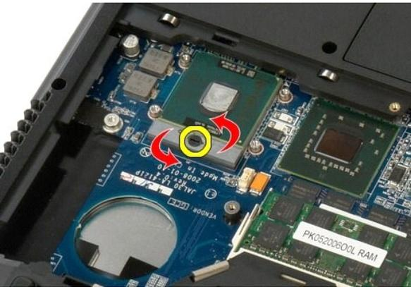
9. プロセッサをソケットからまっすぐに持ち上げます。プロセッサピンを曲げないように注意してください。
