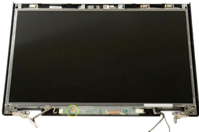
4. ディスプレイインバータのデータケーブルクリップを開きます。
