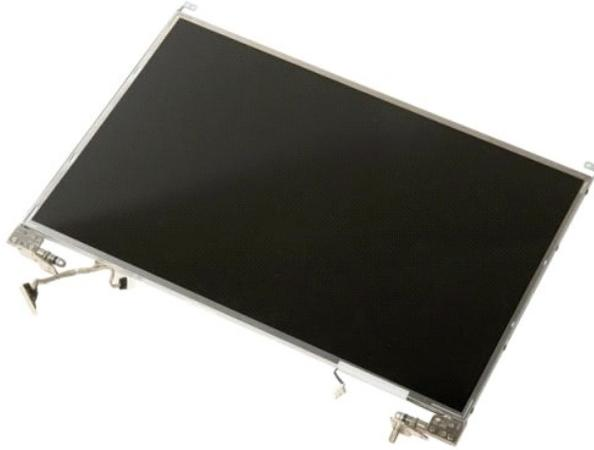
6. ヒンジをディスプレイパネルアセンブリに固定している 8 本のネジを取り外します。
