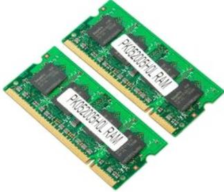
**メモ:** DIMM A はシステム基板に最も近いモジュールです。DIMM A は DIMM B を取り外してからでないと取り外すことができません。DIMM を 1 枚だけ取り付ける場合は、必ず DIMM A スロットに取り付けます。DIMM を 1 枚だけ取り付ける場合は、DIMM A から DIMM B にメモリを移動すると AMT が(現在有効の場合は)無効になります。
