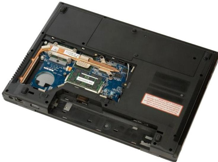
5. ヒートシンクをシステム基板に固定している 6 本の拘束ネジを緩めます。
