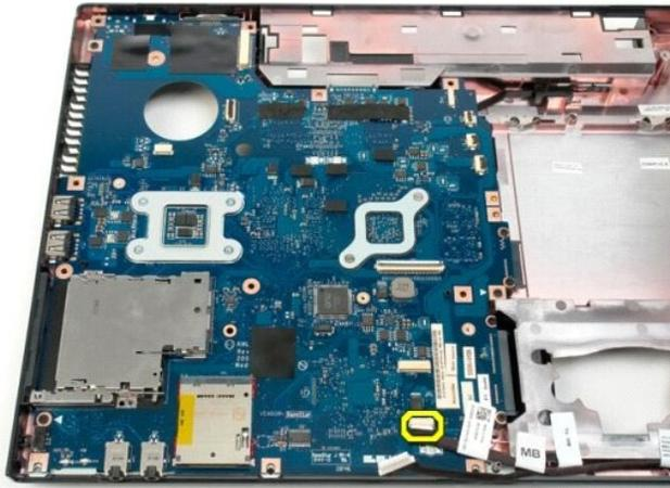
20. システム基板をコンピュータシャーシに固定している 3 本のネジを外します。
