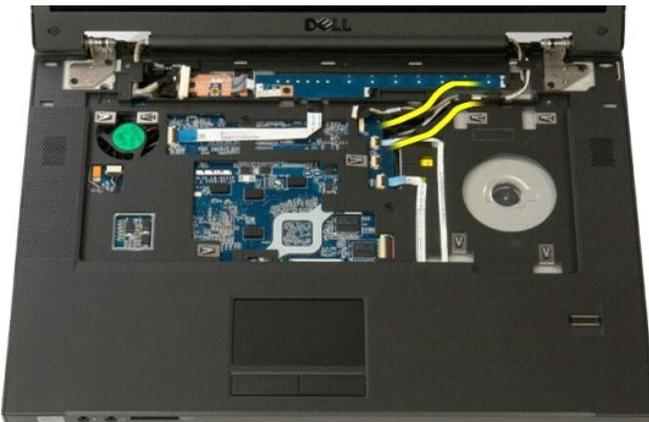
12. アンテナケーブルを配線スロットから外します。
