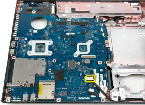
19. 第 2 データケーブルをシステム基板から外します。
