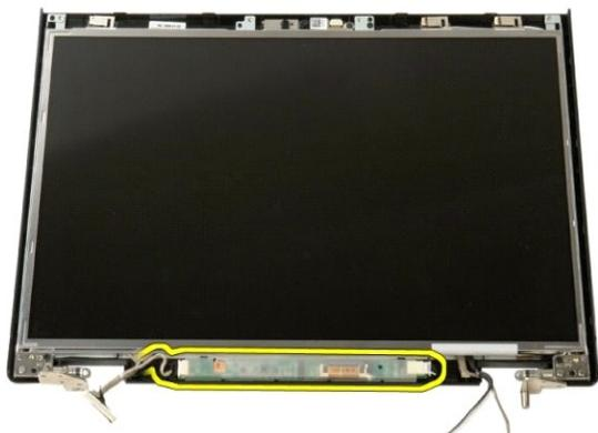
5. ディスプレイインバータのデータケーブルをクリップから外します。
