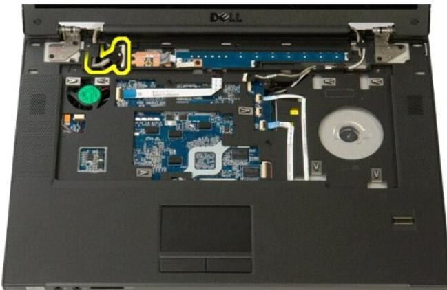
11. アンテナケーブルをシステム基板から注意深く引き出します。
