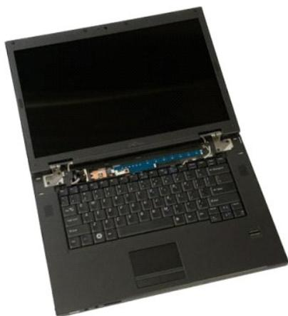
4. キーボードをコンピュータに固定している 2 本のネジを外します。
