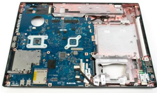
18. 第 1 データケーブルをシステム基板から外します。
