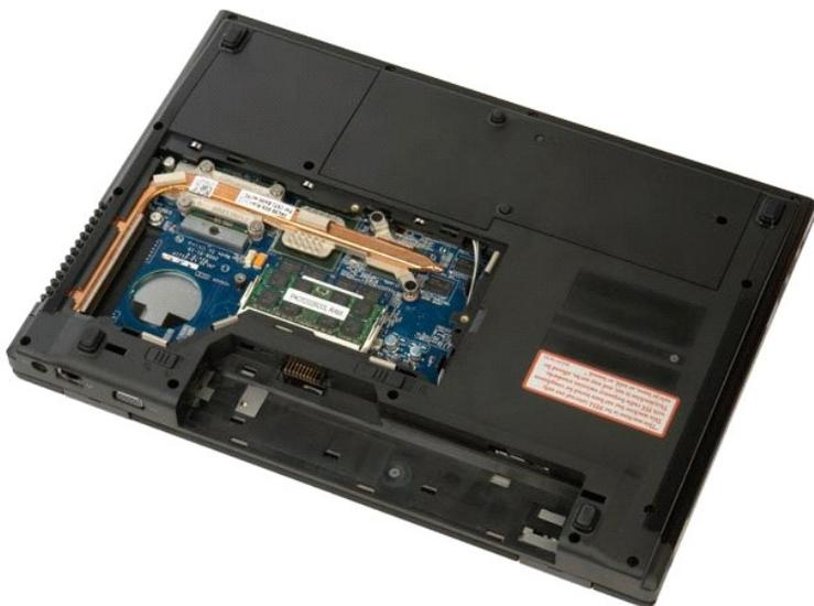
4. Con la punta delle dita allargare con cura i fermagli di fissaggio a ciascuna estremità del connettore del modulo di memoria fino a far scattare il modulo fuori sede.
