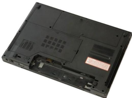
3. Allentare le due viti di fissaggio sul pannello di accesso.
