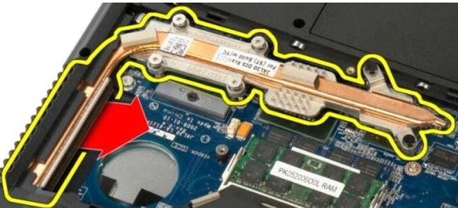
8. Ruotare la vite del processore in senso antiorario.
