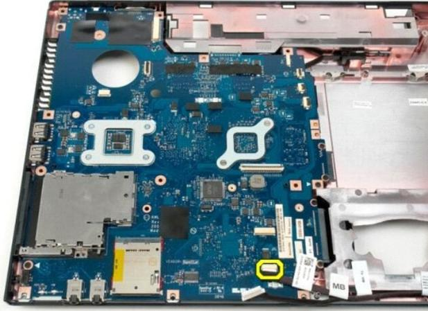
20. Rimuovere le tre viti che fissano la scheda di sistema al telaio del computer.
