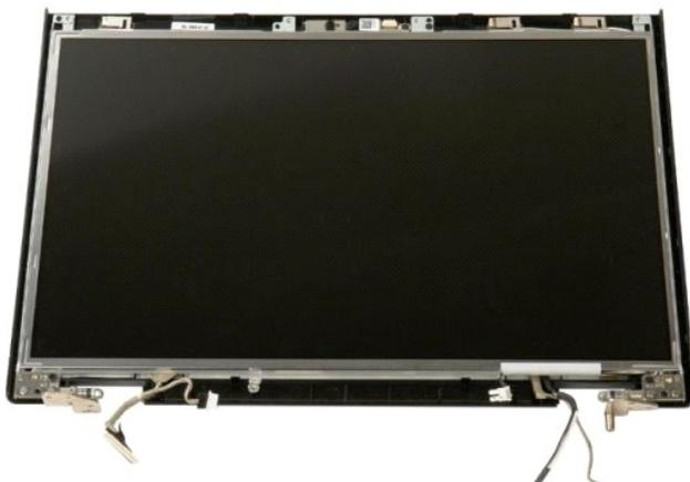
4. Rimuovere le due viti che fissano il pannello dello schermo LCD al gruppo dello schermo.
