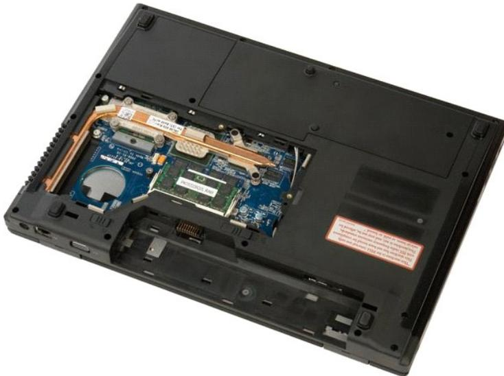
5. Allentare le sei viti di fissaggio che assicurano il dissipatore di calore alla scheda di sistema.
