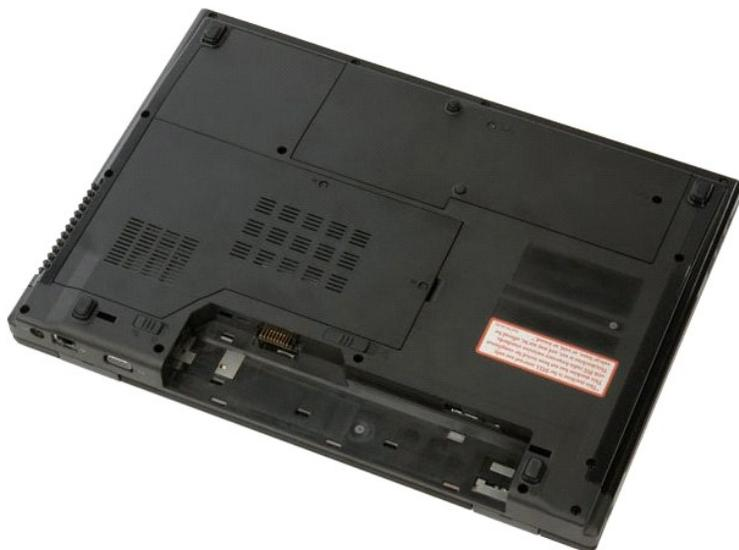
3. Rimuovere le due viti che fissano il pannello di accesso del disco rigido e della Mini-Card al computer.
