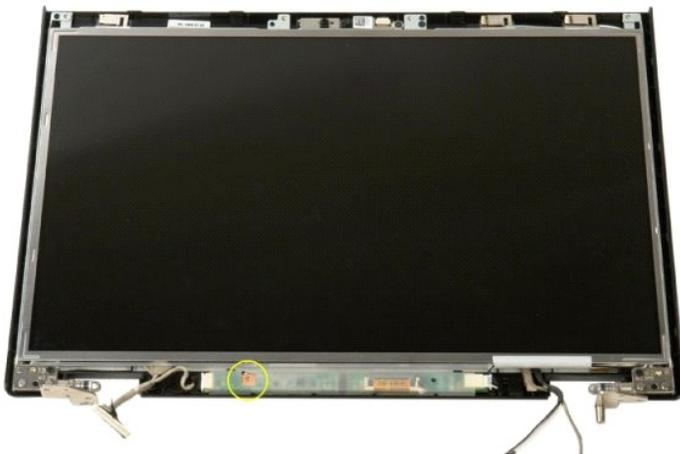
4. Aprire il fermaglio del cavo dati dell'invertitore dello schermo.
