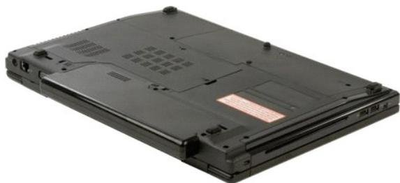
2. Far scorrere il dispositivo di blocco della batteria sulla sinistra per allontanarlo dalla batteria.
