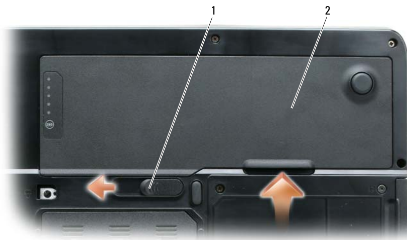
1 az akkumulátorrekesz zárjának kioldója 2 akkumulátor
