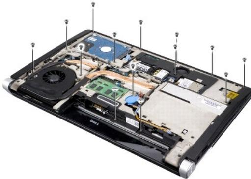
5. コンピュータを表に返し、パームレストの上部から 2 本のネジを外します。
