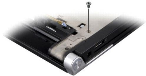
4. コンピュータを表に戻して、光学ドライブをシステム基板に固定している 3 本のネジを外します。
