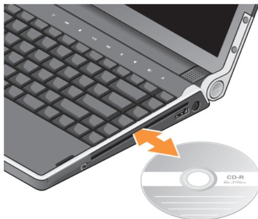
ディスクをドライブから取り出すには、取り出しコントロール
