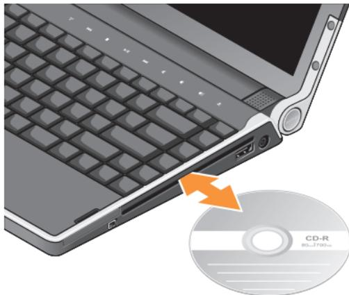
Pour éjecter un disque du lecteur, appuyez doucement sur la commande d'éjection
