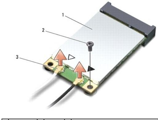
4. Extraiga el tornillo que fija la minitarjeta a la placa base.
