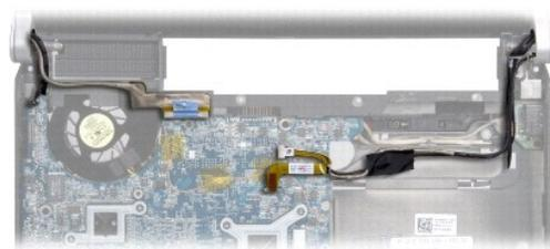
7. Retire el tornillo de toma a tierra del cable de la pantalla que fija el cable a la placa base.
