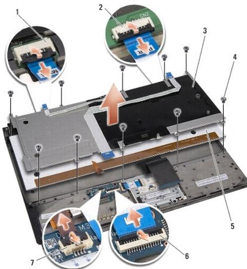
1 | Conector del cable del panel
