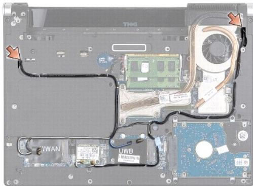
5. Tire de los cables de la minitarjeta a través de la placa base de forma que queden apartados de la base del equipo.
