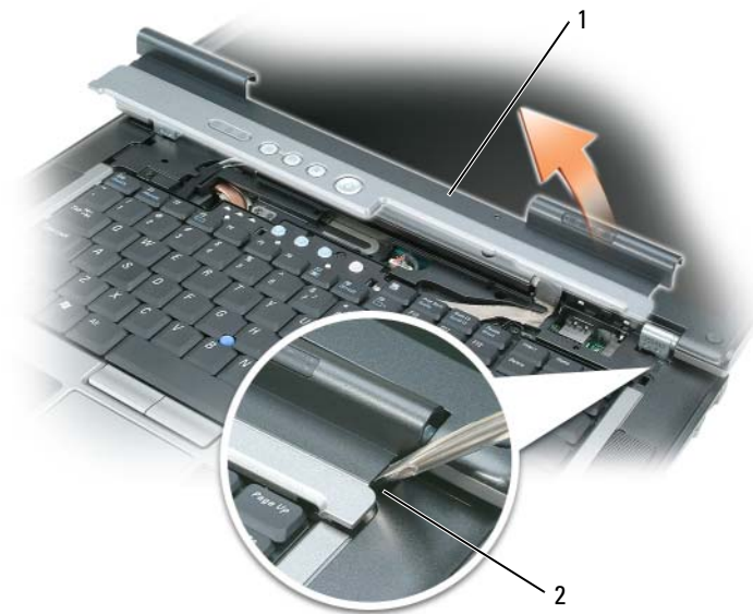
1 Cubierta de las bisagras 2 Muesca
