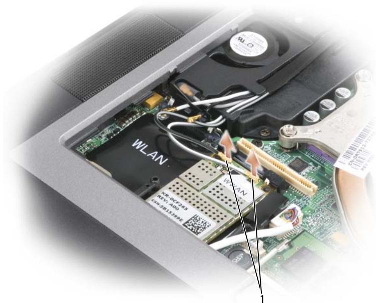
1 Cables de antena
