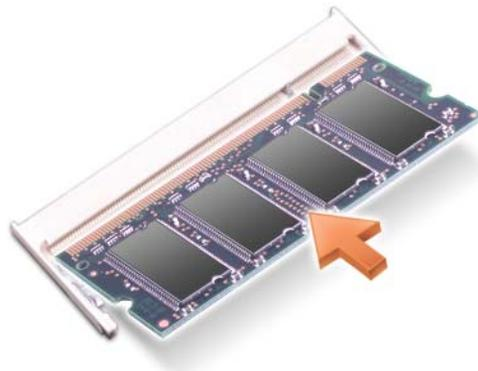
Per aggiungere o sostituire un modulo di memoria nel connettore DIMM B:
