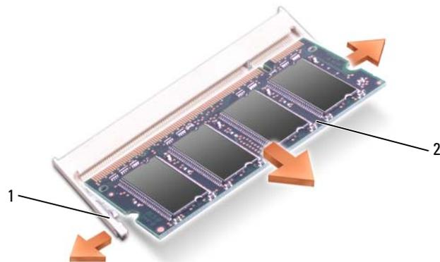
1 fermagli di fissaggio (2 per connettore)    2 modulo di memoria
