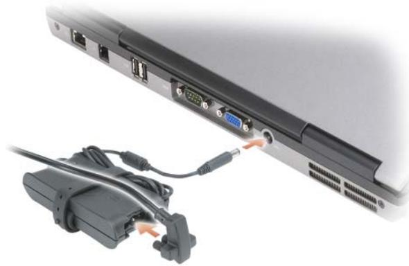
L'adattatore c.a. converte l'alimentazione c.a. in alimentazione c.c. richiesta dal computer. È possibile collegare l'adattatore c.a. quando il computer è acceso o spento.
