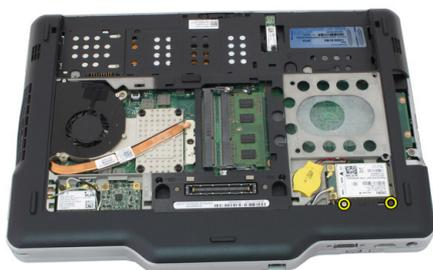
6. Desengate a tampa da base das bordas e retire-a do computador.
