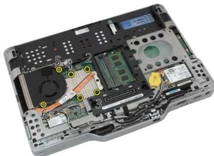
8. Levante o dissipador de calor e retire-o do computador.
