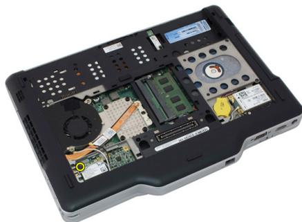
6. Retire a placa WLAN do computador.
