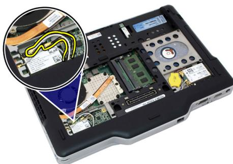
5. Retire o parafuso que fixa a placa WLAN à placa de sistema.
