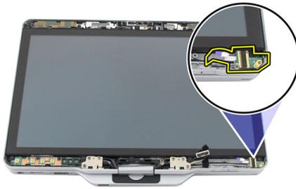
7. Para retirar o cabo da placa de impressões digitais, remova o [conjunto das dobradiças](#).
