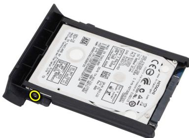
7. Retire o suporte da unidade de disco rígido e faça deslizar para fora a borracha da unidade de disco rígido.
