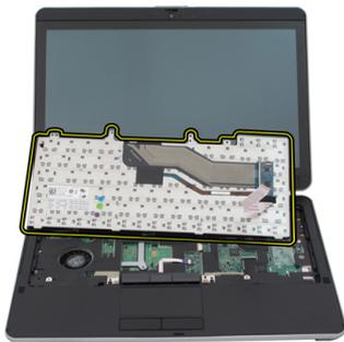
9. Destaque a fita Mylar que fixa o cabo de dados do teclado à parte de trás do teclado.
