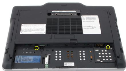
4. Faça deslizar o painel posterior em direcção à parte de trás do computador e depois levante e retire-o do computador.
