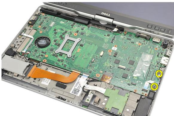
10. Retire a placa do interruptor WLAN do computador.
