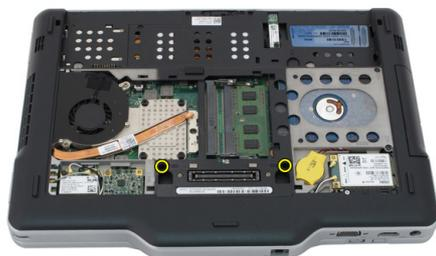
6. Vire o computador ao contrário e retire os parafusos que fixam o teclado.
