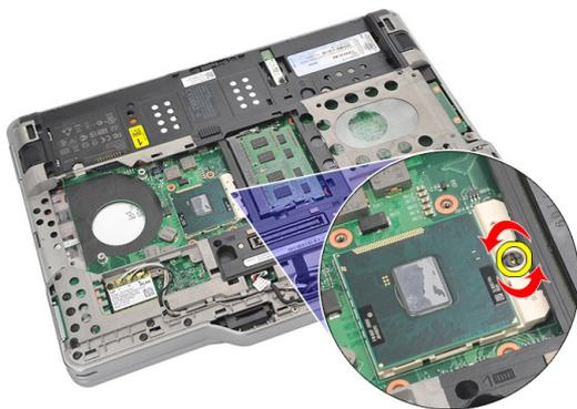
8. Levante e retire o processador do computador.
