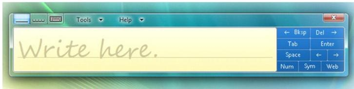
쓰기 패드, 문자 패드 또는 화면 키보드를 사용하여 텍스트를 입력할 수 있습니다. 쓰기 패드 및 문자 패드는 필기 내용을 입력 텍스트로 변환합니다. 화면 키보드는 Tablet 펜으로 키를 가볍게 눌러 텍스트를 입력하는 것을 제외하고 표준 키보드와 동일하게 작동합니다. 다음 표는 다양한 입력판 사용 옵션에 대해 설명합니다.
