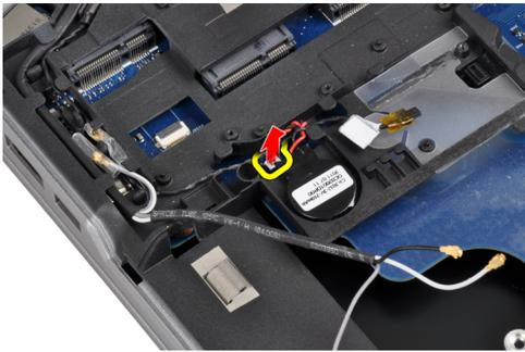
9. Scollegare il cavo dell'altoparlante sul lato superiore della scheda di sistema.
