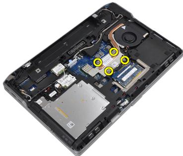
5. Rimuovere il dissipatore di calore dal computer.
