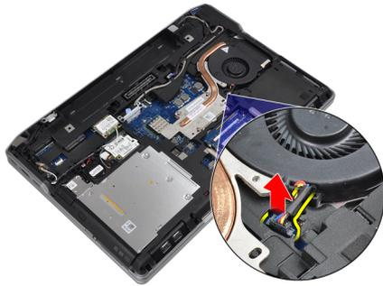
4. Rimuovere le viti che fissano il dissipatore di calore alla scheda di sistema.
