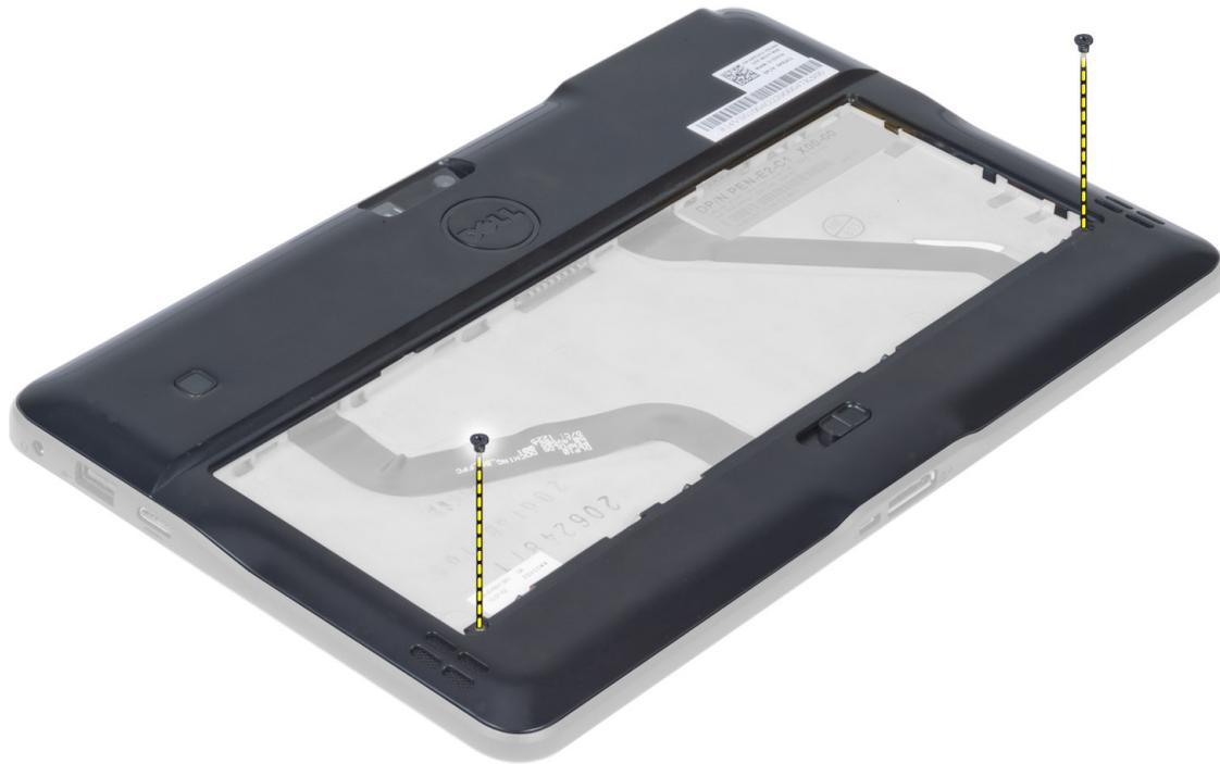
4. Écartez et libérez les languettes de fixation du cache du fond en suivant la séquence fléchée de l'illustration.
