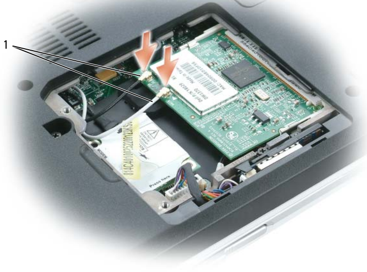
1 Cables de antena
