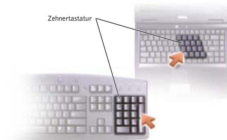
**HINWEIS:** Wenn Sie eine externe PS/2-Tastatur oder -Zehner-tastatur an den Computer anschließen, wird die integrierte Zehner-tastatur deaktiviert.
