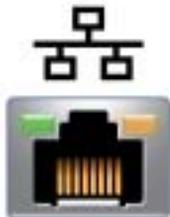
Verbindet den Computer mit einem Netzwerk. Die Leuchtanzeigen neben dem Anschluss zeigen Netzwerkaktivität an (sowohl kabelgebunden als auch kabellos).
