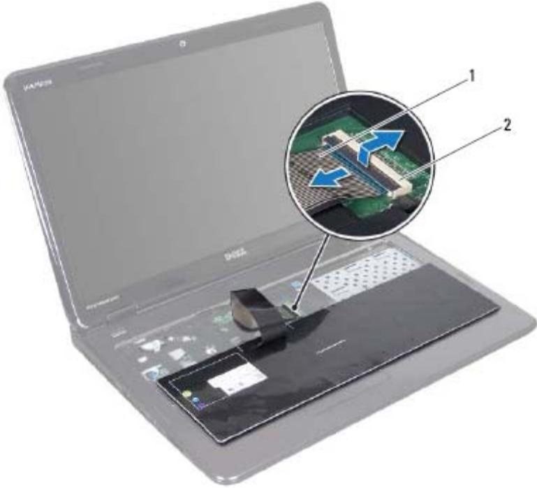
1 كابل لوحة المفاتيح 2 موصل كابل لوحة المفاتيح
