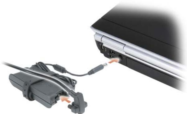
**⚠ PRÉCAUTION : L'adaptateur secteur fonctionne avec les tensions secteur disponibles dans le monde entier. Cependant, les connecteurs et les rampes d'alimentation varient selon les pays. L'utilisation d'un câble non compatible ou le branchement incorrect du câble sur la rampe d'alimentation ou la prise secteur peuvent provoquer un incendie ou endommager l'équipement.**
