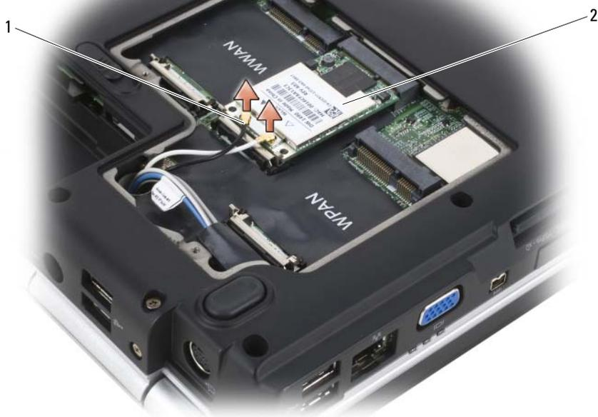
1 câbles de connecteurs d'antenne (2) 2 carte WLAN
