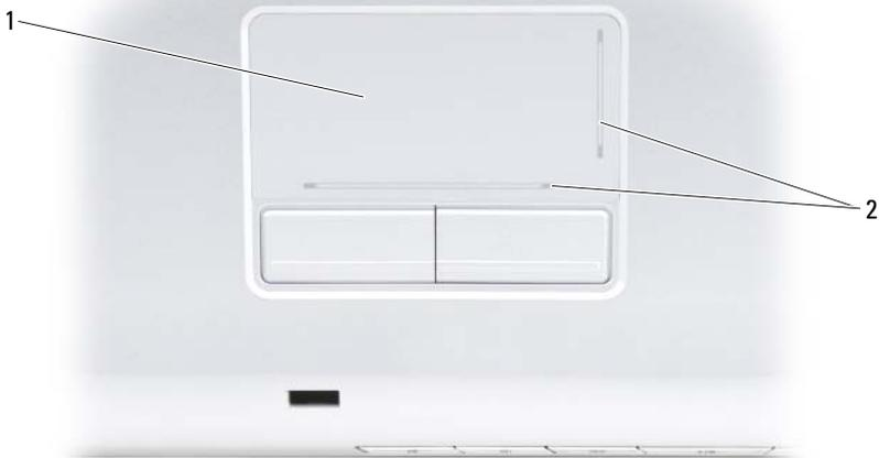
1 tablette tactile 2 sérigraphie indiquant les fonctions de défilement
