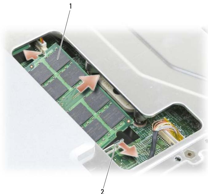
1 module de mémoire (DIMM A) 2 clips de fixation (2)
