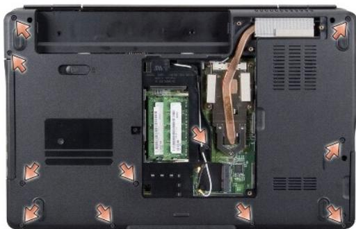
11. Déle la vuelta al equipo y extraiga los cinco tornillos de la parte superior del reposamanos.
