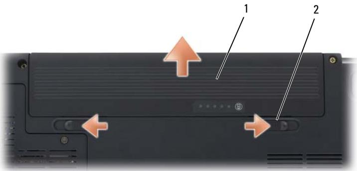
1 batterie      2 loquets de fermeture de batterie (2)
