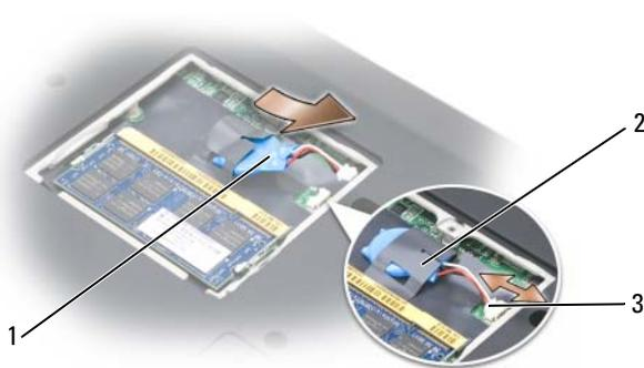
1 pile bouton    2 manchon en mylar    3 connecteur du câble de la pile
