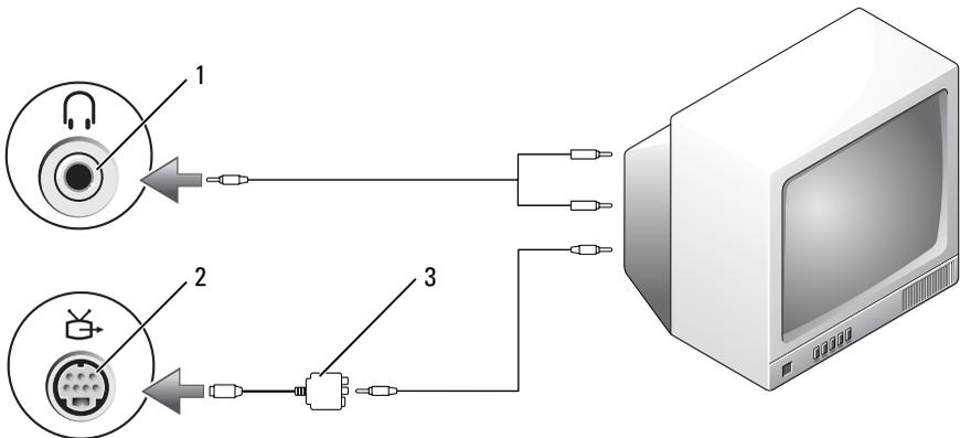
1 connecteur d'entrée audio 2 connecteur de sortie TV S-vidéo
