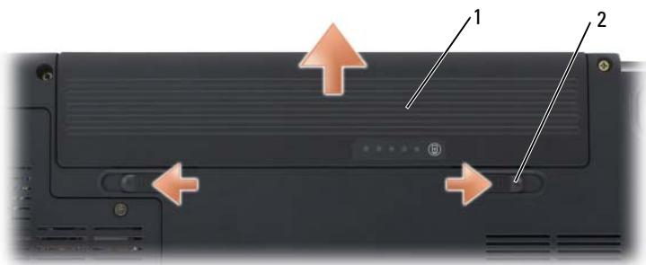
1 batterie 2 loquets de fermeture de batterie (2)
