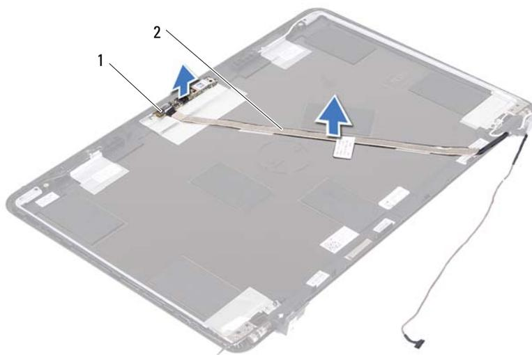
1 modulo della videocamera                      2 cavo della videocamera
