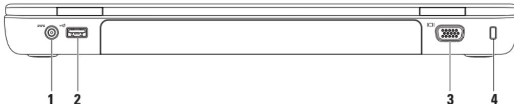
1 موصل محول التيار المتردد - يتصل بمحول التيار المتردد لإمداد الكمبيوتر بالطاقة ولشحن البطارية.
