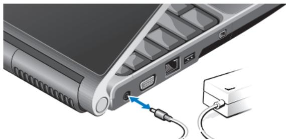
**⚠ VORSICHT: Der Netzadapter funktioniert mit allen Steckdosen weltweit. Allerdings können die Stromkabelstecker und Steckerleisten von Land zu Land variieren. Wird ein falsches Kabel verwendet oder dieses nicht ordnungsgemäß an die Steckerleiste oder die Steckdose angeschlossen, können ein Brand oder Schäden im System verursacht werden.**
