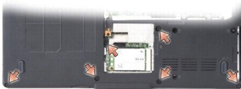
8. Dé la vuelta al ordenador y retire los cuatro tornillos de la parte superior del reposamanos.
