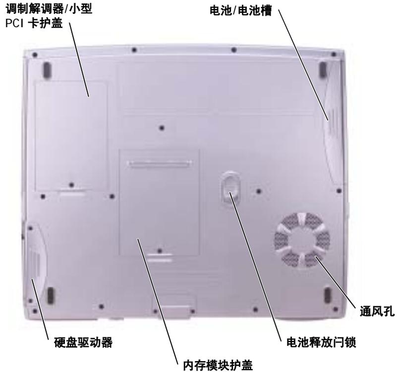
**调制解调器/小型 PCI 卡护盖** — 用于保护安装调制解调器和小型 PCI 卡的凹槽。请参阅第 97 页。
