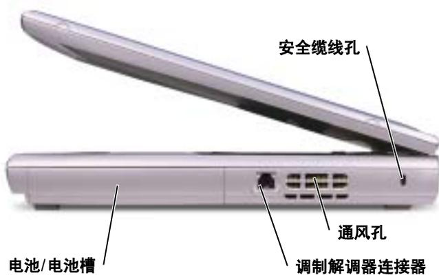
**电池/电池槽** — 在电池槽中安装电池后您即可使用计算机，而不必将计算机连接至电源插座。请参阅第 39 页。
