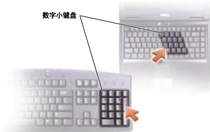
此数字小键盘的功能类似于外部键盘上的数字小键盘。小键盘上的每个按钮均具有多种功能。小键盘的数字和符号标为蓝色，位于小键盘按钮的右侧。
