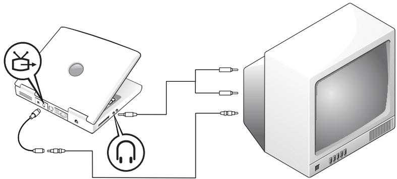
要将计算机连接至只带有复合视频输入的电视，请使用复合电视输出适配器电缆：
