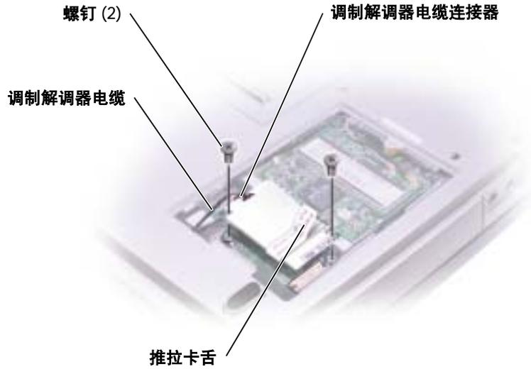
4 将调制解调器电缆连接至调制解调器。
