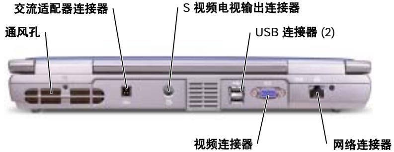
**通风孔** — 计算机使用内部风扇使空气经通风孔流通，从而防止计算机过热。
