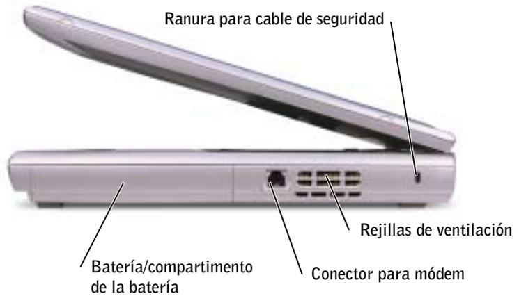
**BATERÍA/COMPARTIMENTO DE LA BATERÍA** — Si tiene instalada una batería, puede utilizar el ordenador sin conectarlo a una toma de corriente. Consulte la página 41.
