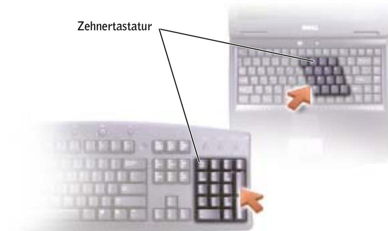
Die Zehnertastatur entspricht dem numerischen Tastenblock einer externen Tastatur. Jede Taste hat mehrere Funktionen. Die Zahlen und Symbole der Zehnertastatur sind in blauer Schrift rechts auf den entsprechenden Tasten angegeben.
