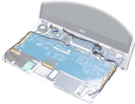
6. Conecte el cable de la tarjeta dependiente izquierda al conector de la placa base (consulte el apartado [Colocación de la tarjeta dependiente izquierda](#)).
