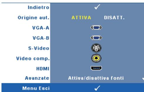
**ORIGINE AUT.**—Selezionare **Disatt.** (opzione predefinita) per bloccare il segnale di ingresso corrente. Se si preme il tasto **Sorgente** quando si imposta la modalità **Origine aut.** su **Disatt.**, è possibile selezionare manualmente il segnale di ingresso. Selezionare **Attiva** per rilevare automaticamente i segnali di ingresso disponibili. Se viene premuto il tasto **Sorgente**
