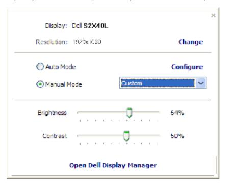
Kotak dialog Pengaturan Ringkas juga memberikan akses ke antarmuka pengguna lanjutan Dell Display Manager yang digunakan untuk menyesuaikan fungsi Dasar, mengkonfigurasi Mode Otomatis, dan mengakses berbagai fitur lainnya.
