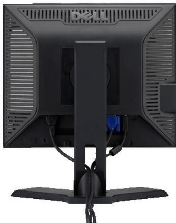
Después de conectar todos los cables necesarios al monitor y al equipo, (consulte [Conectar su monitor](#)) utilice la sujeción de cables para organizarlos correctamente tal y como se muestra en la imagen anterior.
