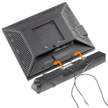
1. Desde la parte trasera del monitor, acople la Barra de Sonido alineando las dos ranuras con las dos pestañas de la parte trasera e inferior del monitor.
