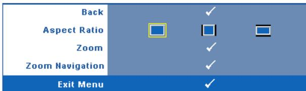
**ASPECT RATIO (PROPORÇÃO)**—Permite selecionar a proporção para ajustar a exibição da imagem.
