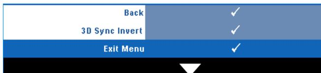
**3D Sync Invert (Inverter Sincronização 3D)**—Se você ver uma imagem discreta ou sobreposta ao usar óculos DLP 3D, você pode precisar executar 'Inversão' para obter a melhor combinação de sequência de imagem esquerda/direita para obter a imagem correta. (Para óculos DLP 3D)
