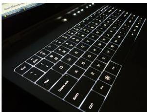
O teclado retroiluminado dos portáteis da Dell possui diferentes estados de iluminação. Pressione a tecla <Fn> e a tecla de seta para a direita para alternar entre os vários estados de iluminação.
