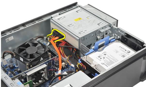
4. Tirare il dispositivo di chiusura dell'unità ottica e spingere l'unità ottica nella parte anteriore del computer.
