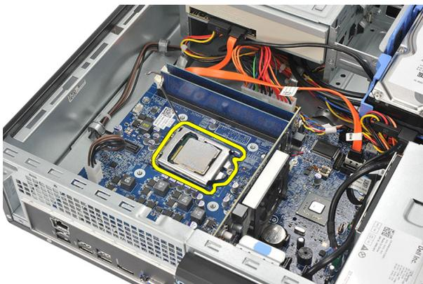
8. Sollevare il processore per rimuoverlo dalla presa e collocarlo nell'involucro antistatico.
