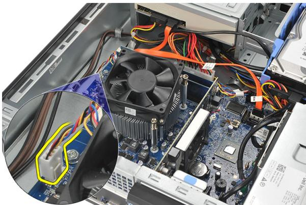
4. Allentare le viti di fissaggio che tengono fermo il gruppo dissipatore di calore e ventola alla scheda di sistema.
