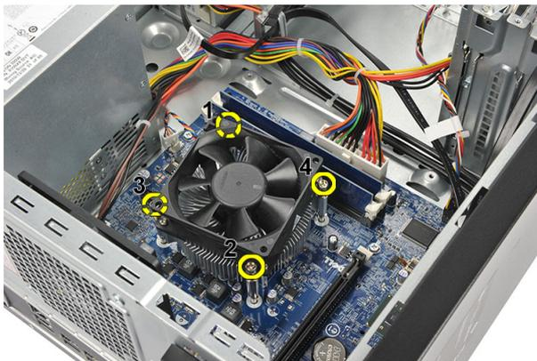
5. Приподнимите блок радиатора с вентилятором в сборе и извлеките его из корпуса компьютера.
