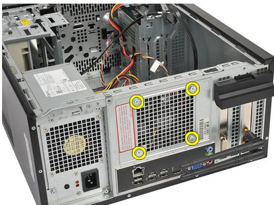
5. Извлеките вентилятор из корпуса компьютера.
