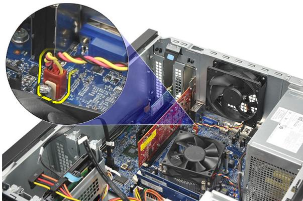
4. Выверните винты, которыми вентилятор крепится к корпусу компьютера.
