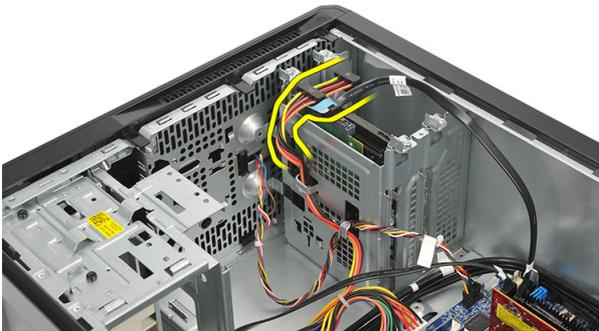
4. Выверните винты, которыми жесткий диск крепится к корпусу компьютера.
