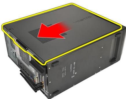
4. Снимите крышку компьютера.
