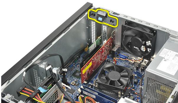
4. Нажмите на рычажок фиксатора чтобы высвободить защелку из выемки в плате.
