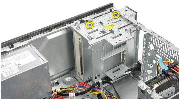
5. Выдвиньте оптический дисковод через переднюю часть компьютера.
