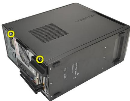
3. Сдвиньте крышку в сторону задней части компьютера.
