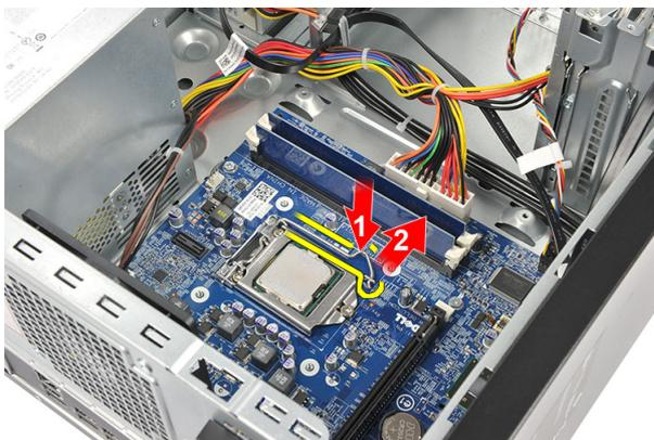
7. Приподнимите крышку процессора.
