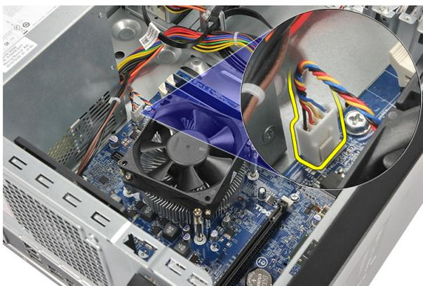
4. Ослабьте невыпадающие винты, которыми блок радиатора с вентилятором в сборе крепится к системной плате.
