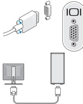
c VGA-Kabel mit DVI-Adapter
