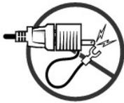
綠色接地線與電源導線接觸，否則可能導致觸電、火災或電腦損壞。
