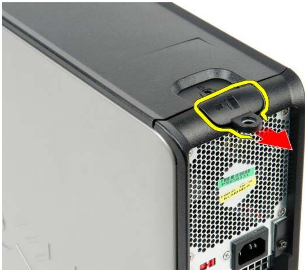
3. Incline a tampa para fora da parte superior e, em seguida, remova a tampa do computador.
