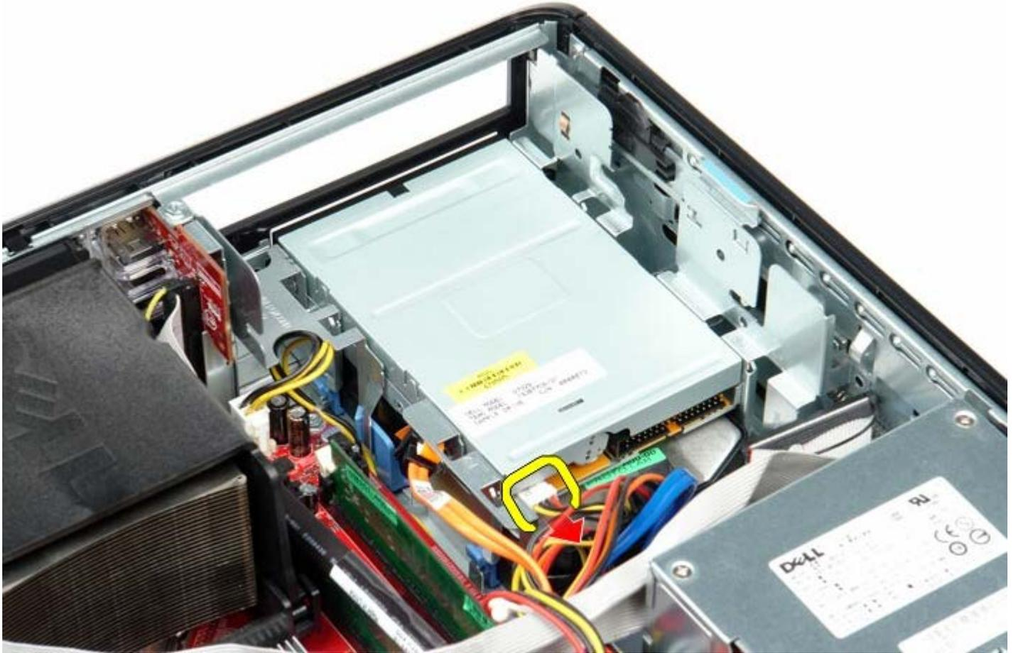
4. Puxe a trava de liberação da unidade para cima e deslize a unidade de disquete em direção à parte de trás do computador.
