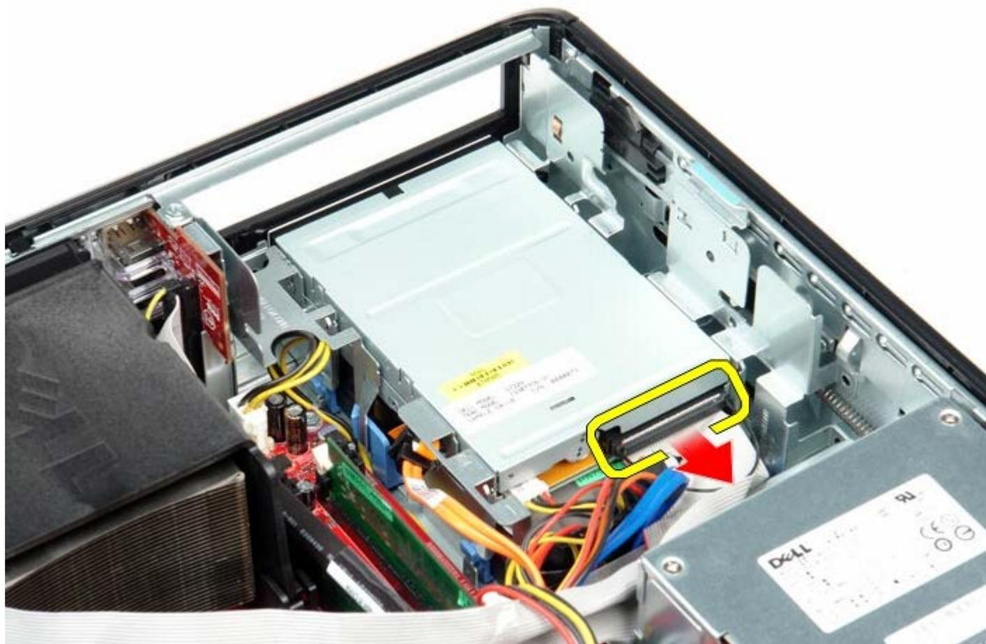
3. Desconecte o cabo de alimentação da unidade de disquete.
