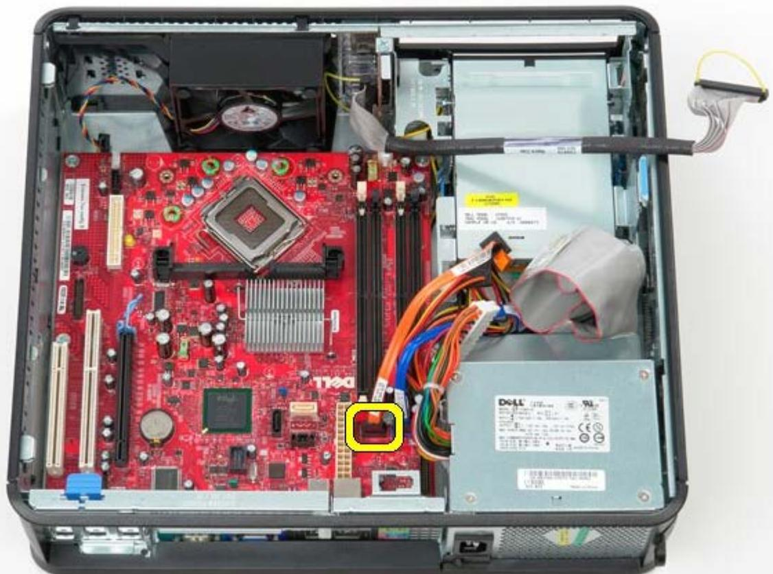
10. Desconecte o cabo de dados do disco rígido da placa de sistema.
