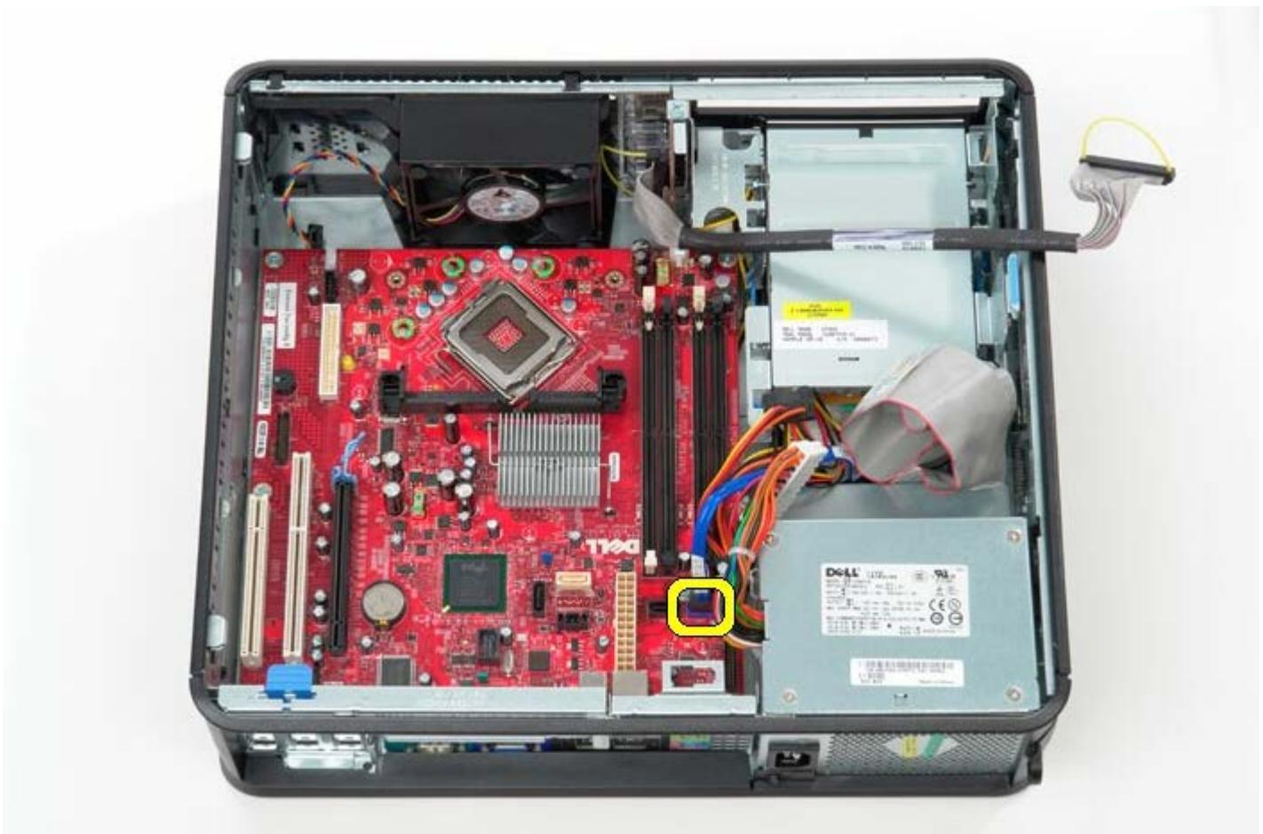
11. Desconecte o cabo de alimentação do processador.
