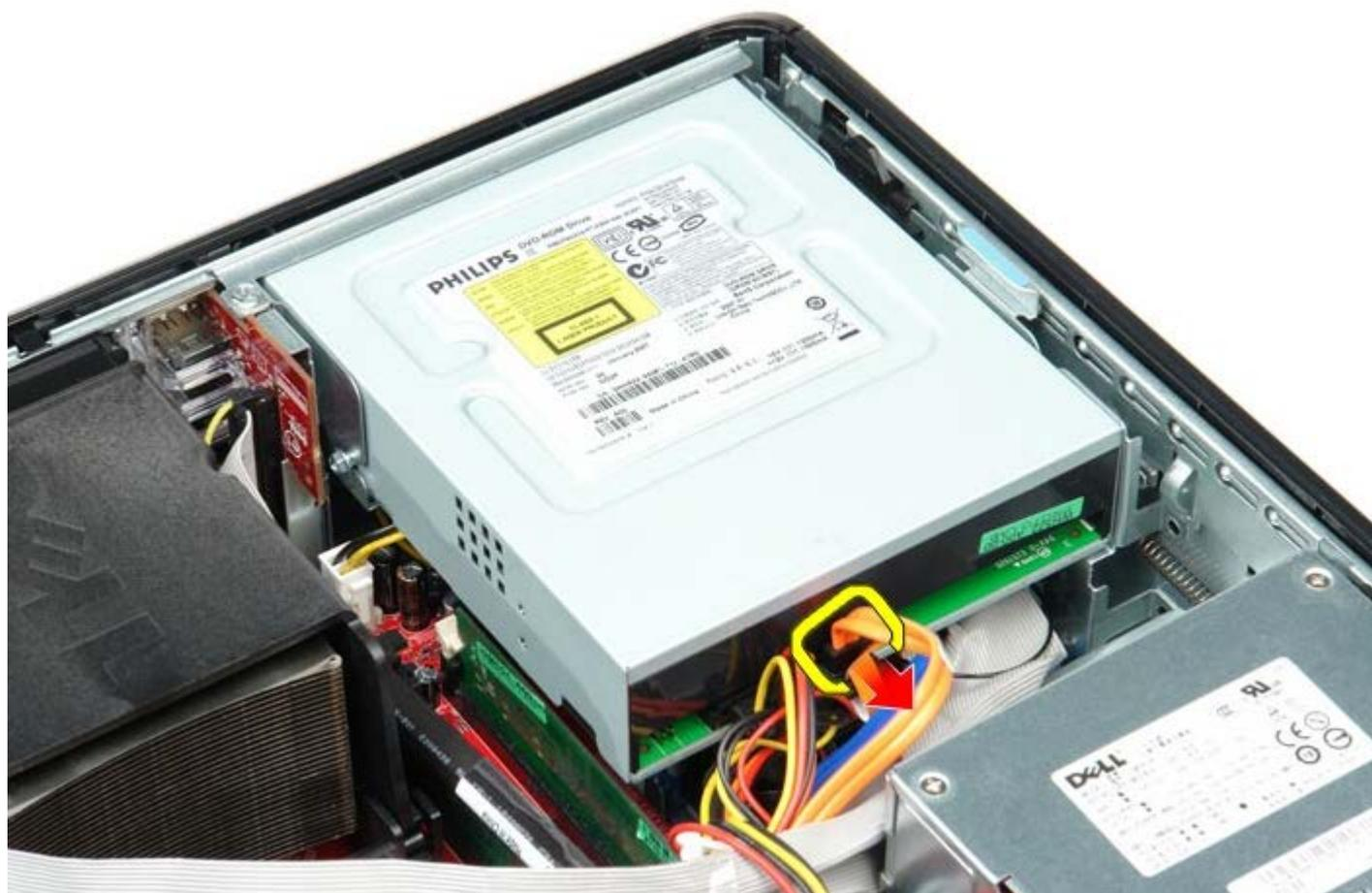
3. Desconecte o cabo de alimentação da unidade óptica.
