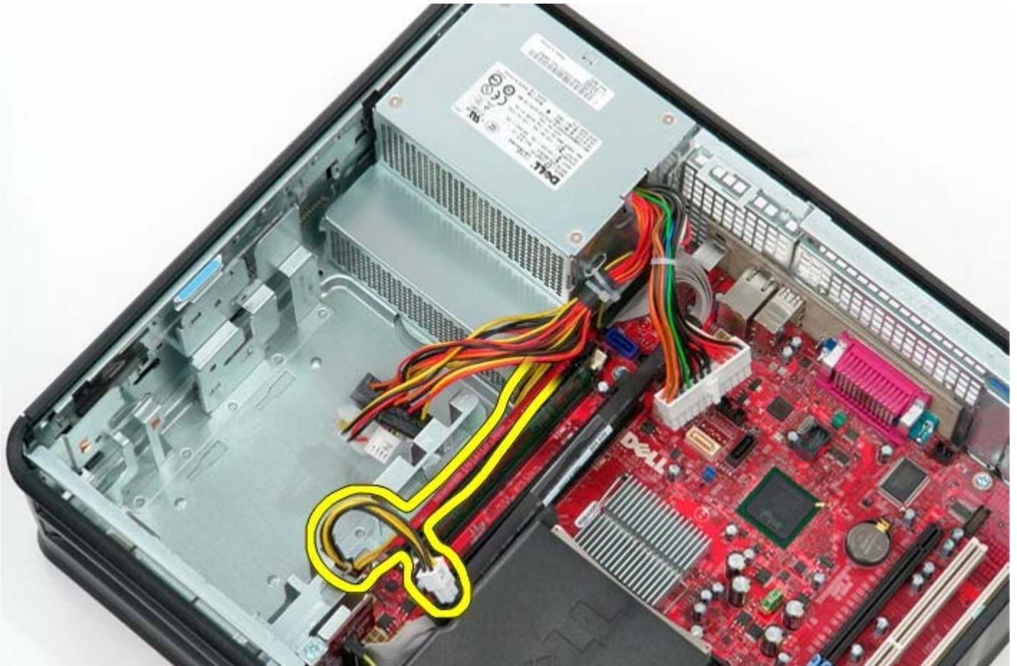
8. Remova os parafusos que prendem a fonte de alimentação à parte de trás do chassi.
