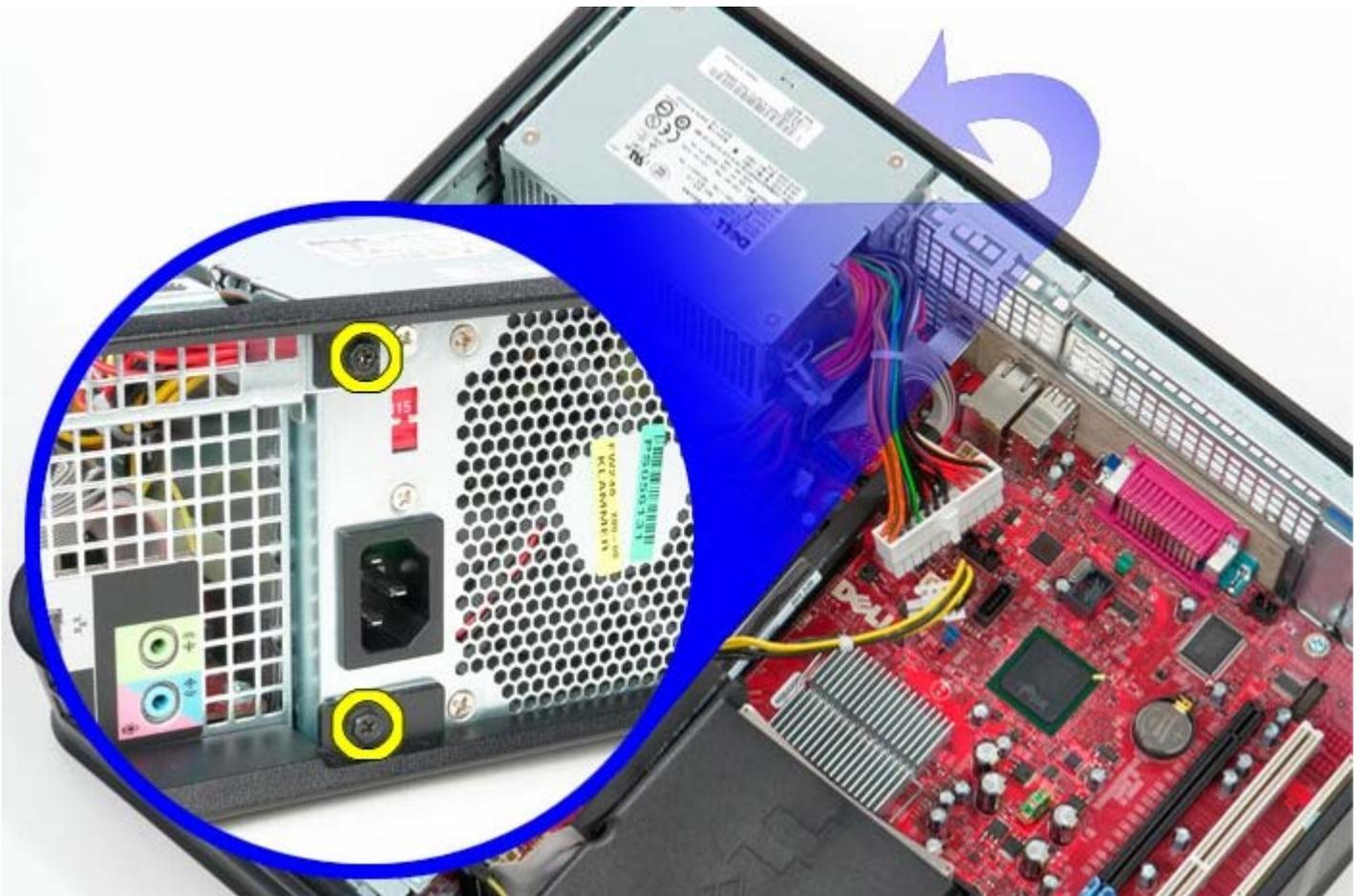
9. Pressione a trava de liberação da fonte de alimentação na parte inferior do chassi e, em seguida, deslize a fonte de alimentação em direção à frente do computador.
