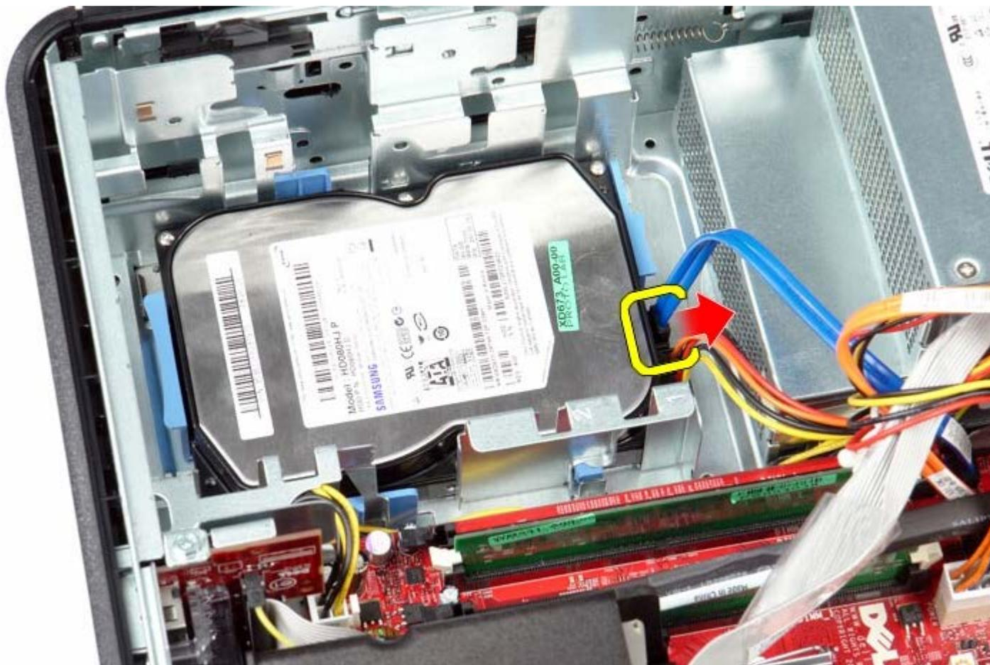
5. Desconecte o cabo de alimentação da unidade de disco rígido.
