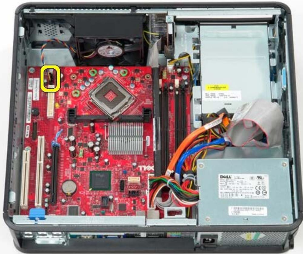
7. Desconecte o cabo de alimentação principal da placa de sistema.
