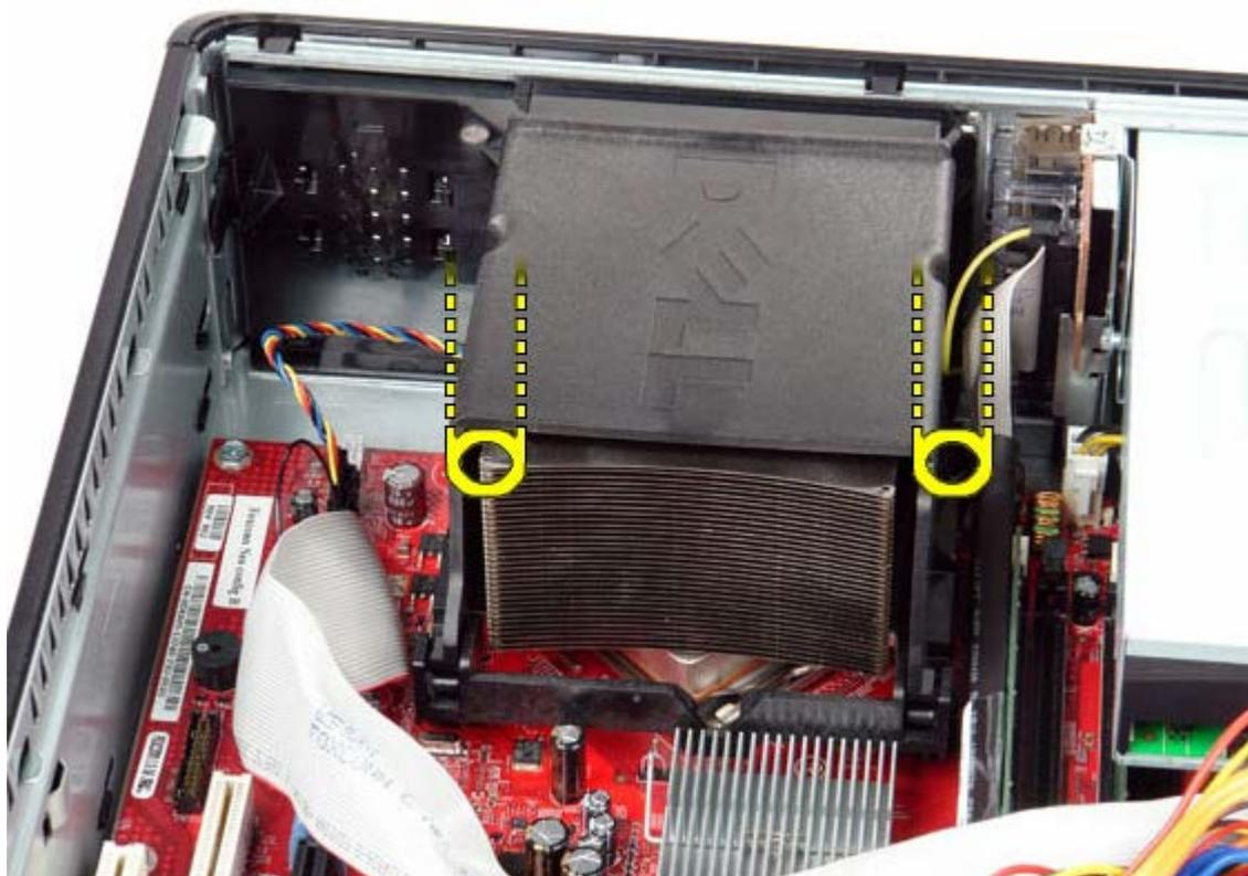
3. Gire o dissipador de calor para cima.
