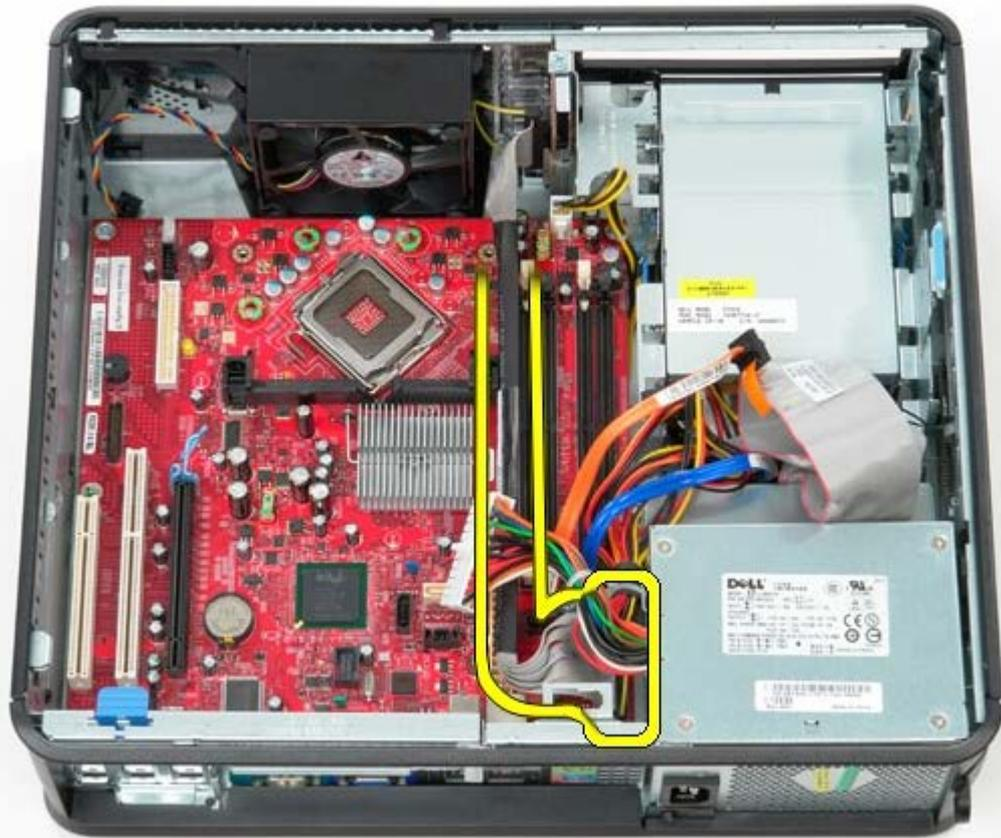
9. Desconecte o cabo de dados da unidade óptica da placa de sistema.
