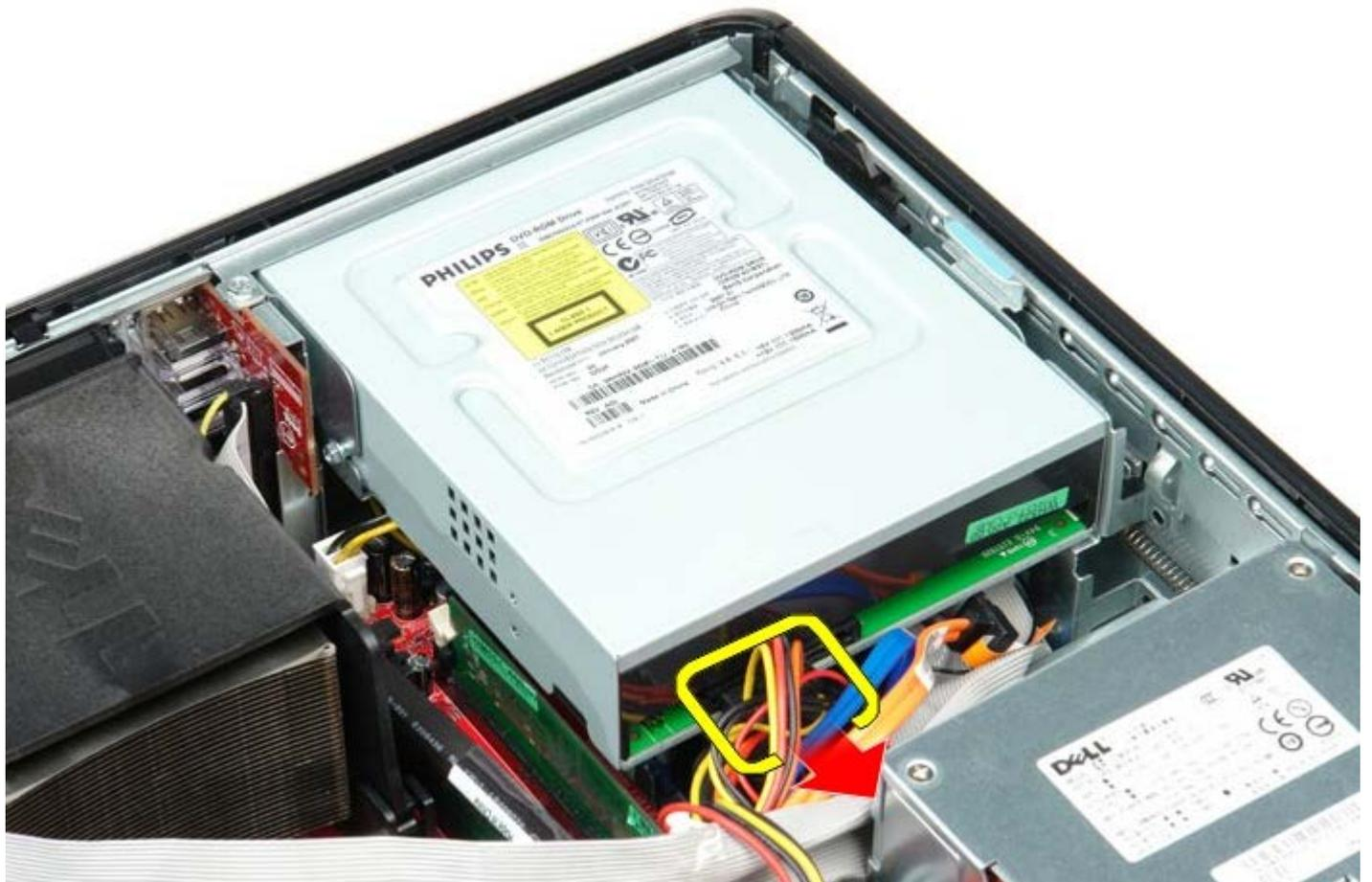
4. Levante a trava de liberação da unidade e deslize a unidade em direção à parte de trás do computador.
