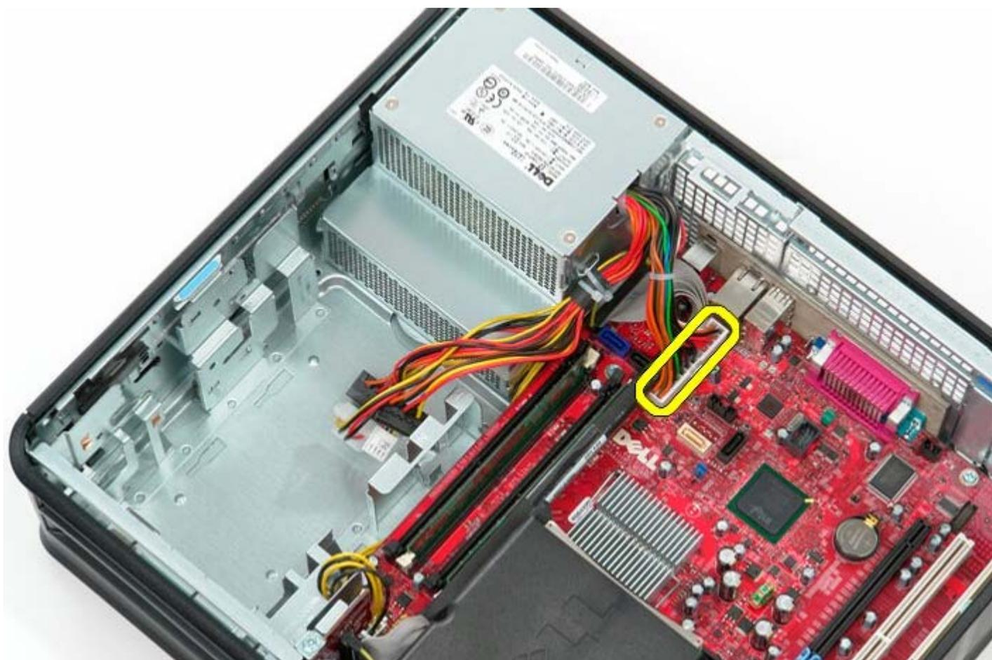
6. Desconecte o conector de alimentação do processador da placa de sistema.
