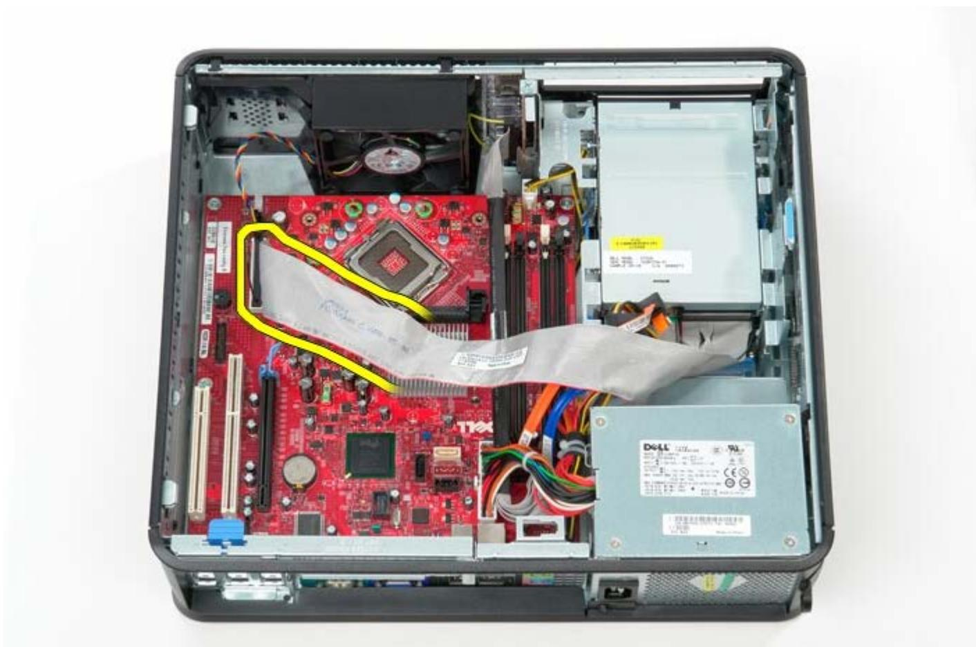
6. Desconecte o cabo de alimentação do ventilador.
