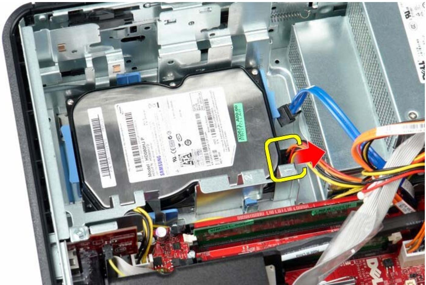
6. Pressione as abas de fixação azuis em cada lado da unidade e deslize a unidade em direção à parte traseira do computador.
