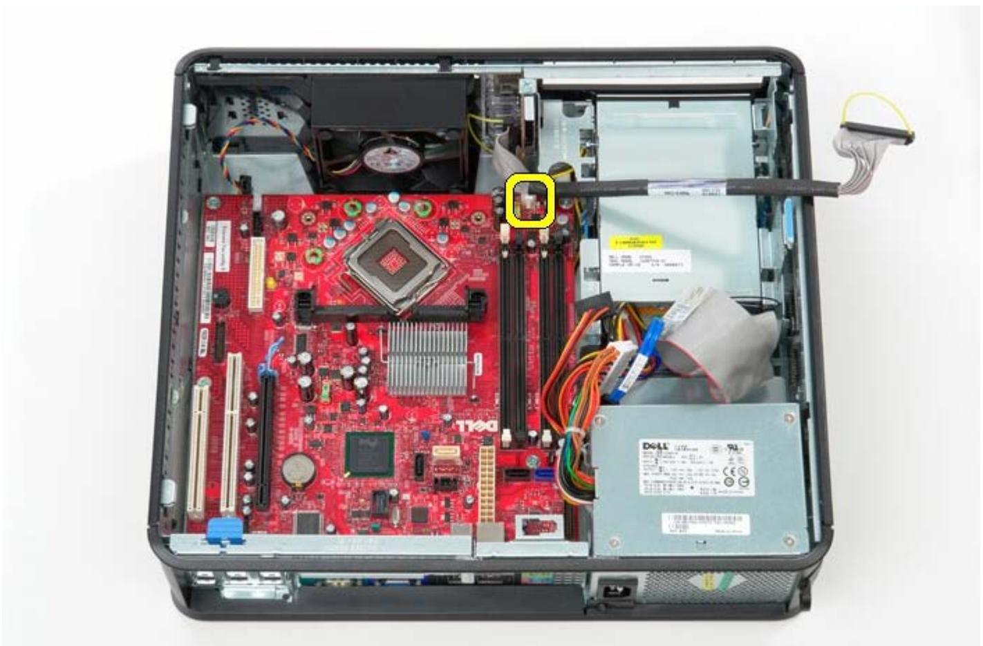
12. Remova os parafusos que prendem a placa de sistema ao chassi do computador.
