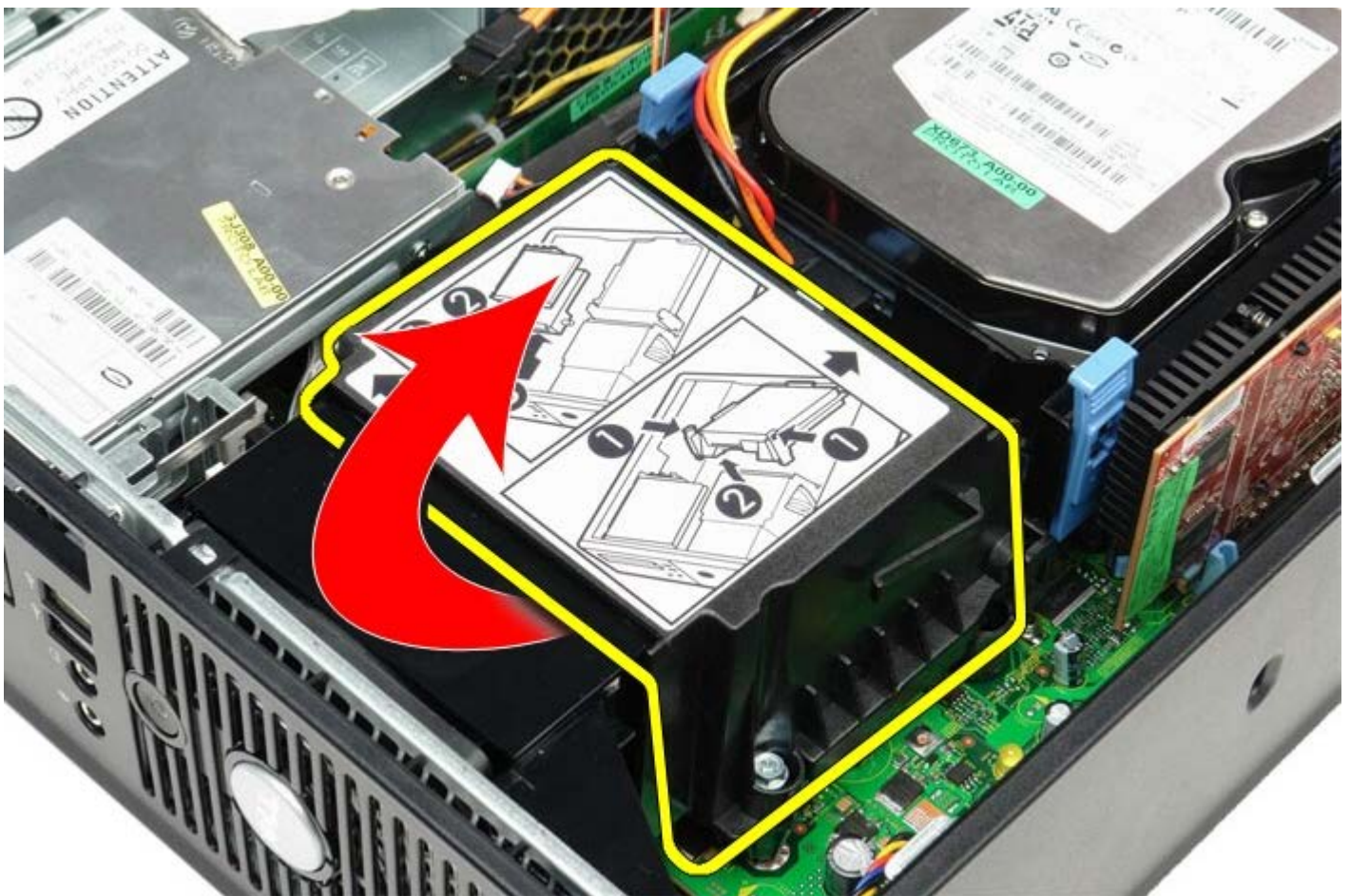
5. לחץ על ידית שחרור מכסה המעבד לכיוון מטה והחוצה כדי לשחרר את מכסה המעבד.
