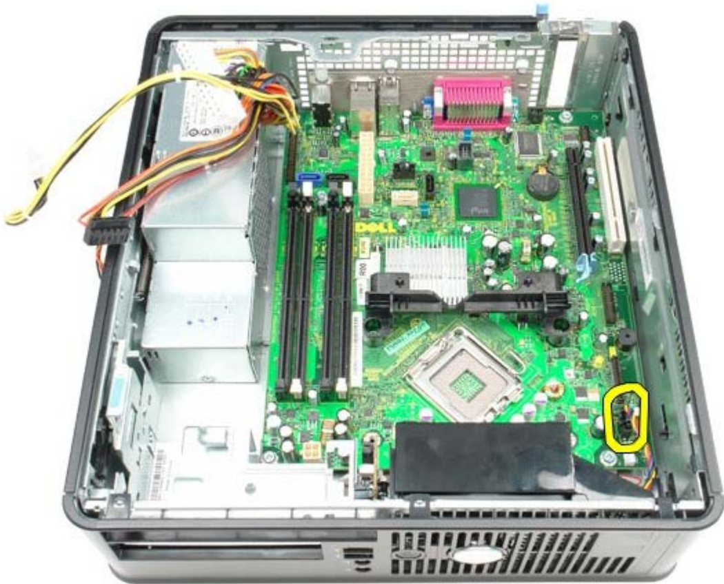
13. הסר את הברגים המחברים את מכלול גוף הקירור אל לוח המערכת.
