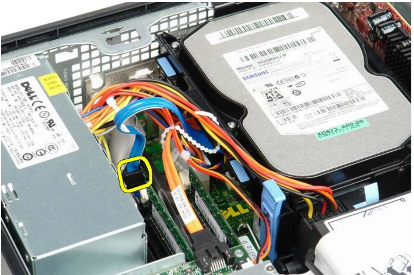
4. לחץ על הלשוניות הכחולות שמשני צידי מסגרת הכונן, ואז החלק את הכונן לכיוון מעלה אל מחוץ למחשב.
