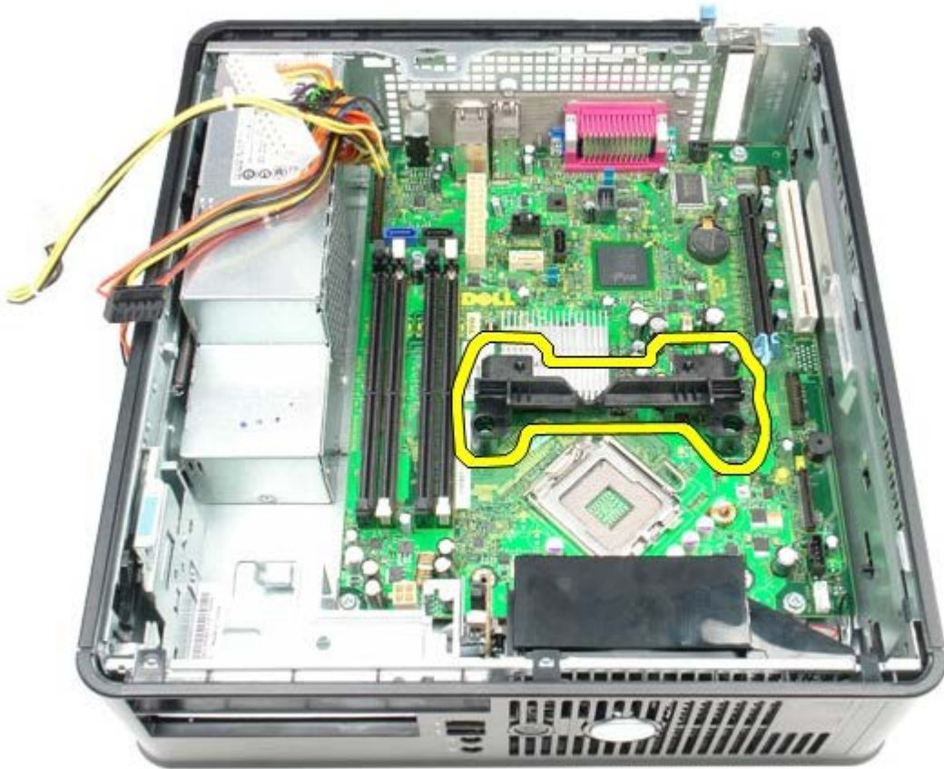
15. הסר את הברגים המאבטחים את לוח המערכת למארז המחשב.
