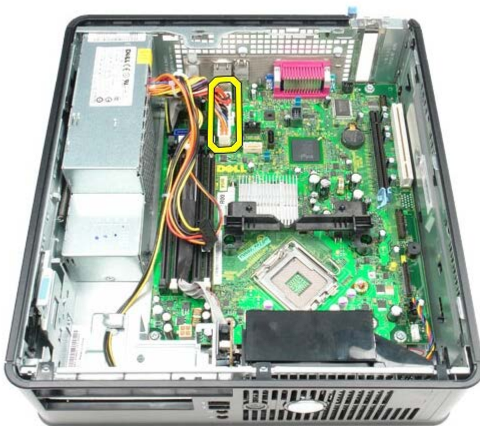
11. הסר את כבל לוח הקלט/פלט מלוח המערכת.
