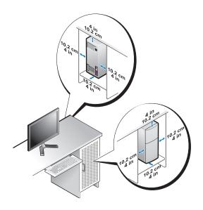
• Если компьютер устанавливается в угол рабочего стола или под стол, оставьте зазор не менее 5,1 см (2 дюйма) между задней панелью компьютера и стенкой (перегородкой), чтобы обеспечить приток воздуха, необходимый для надлежащей вентиляции.
